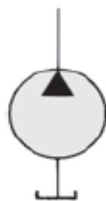
Slika 3.2: b) Shematski simbol zupčaste pumpe s vanjskim ozubljenjem [4]
