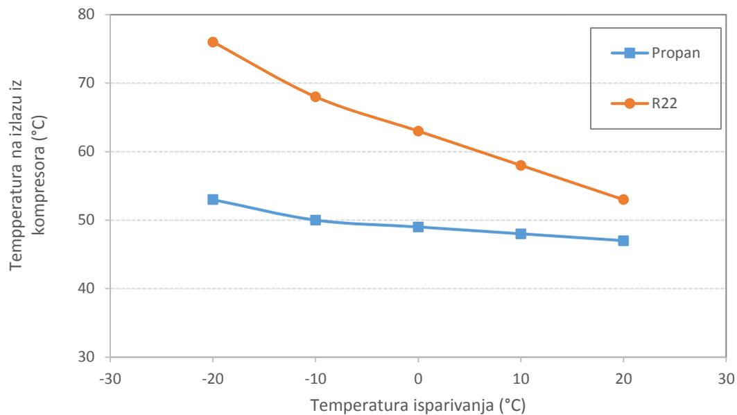
**Slika 9** Temperatura na izlazu iz kompresora u odnosu na temperaturu isparivanja, pri temperaturi kondenzacije 40 °C, 0 °C pothlađenja i 5 °C pregrijanja
