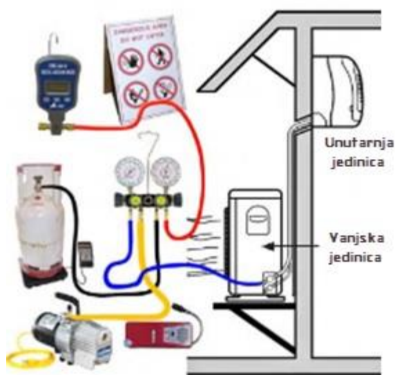
Slika 31 Oprema za vakumiranje i punjenje sustava [5],[12]
