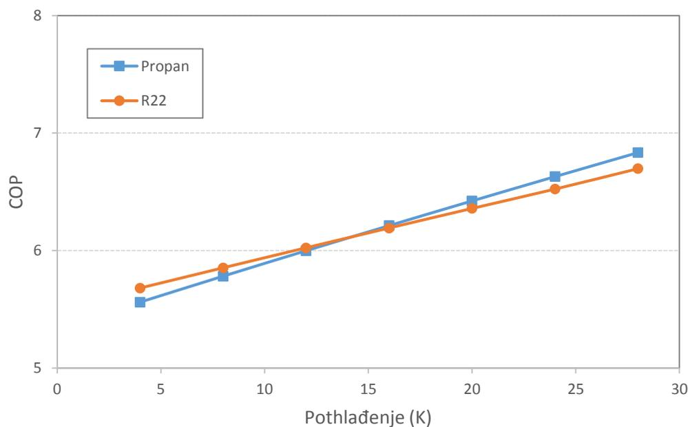
**Slika 7 Utjecaj pothlađenja na COP, pri temperaturi kondenzacije 40 °C, temperaturi isparivanja 0 °C i 5 °C pregrijanja**
