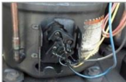
Slika 25 Žičani spojevi i izolacija [4]
