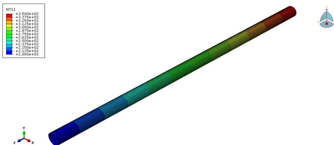
Slika 40: Raspodjela temperatura duž grede u mm
