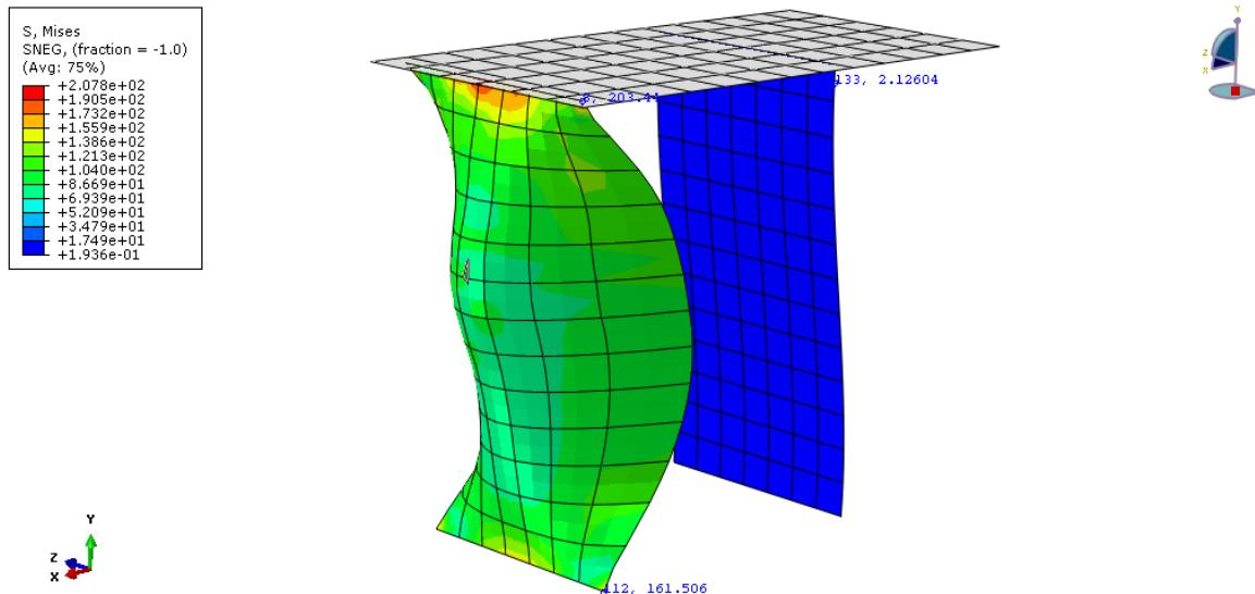
Slika 67: Raspodjela naprezanja za model s 312 elemenata u MPa
