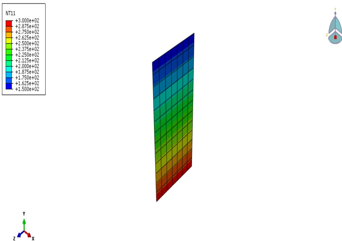
Slika 77: Prikaz raspodjele temperature na srednjoj ploči u °C
