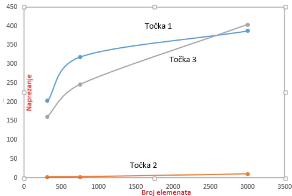
Slika 74: Konvergencija naprezanja za 3 karakteristične točke
