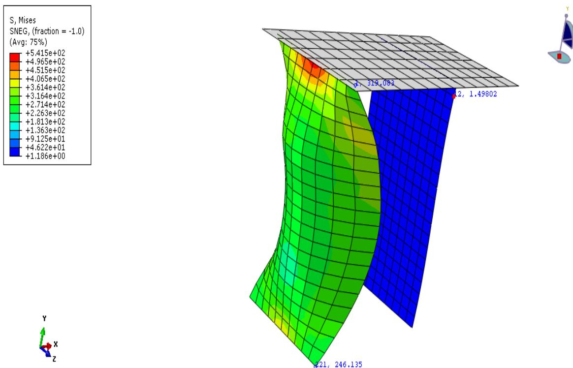
Slika 68: Raspodjela naprezanja za model s 750 elemenata u MPa
