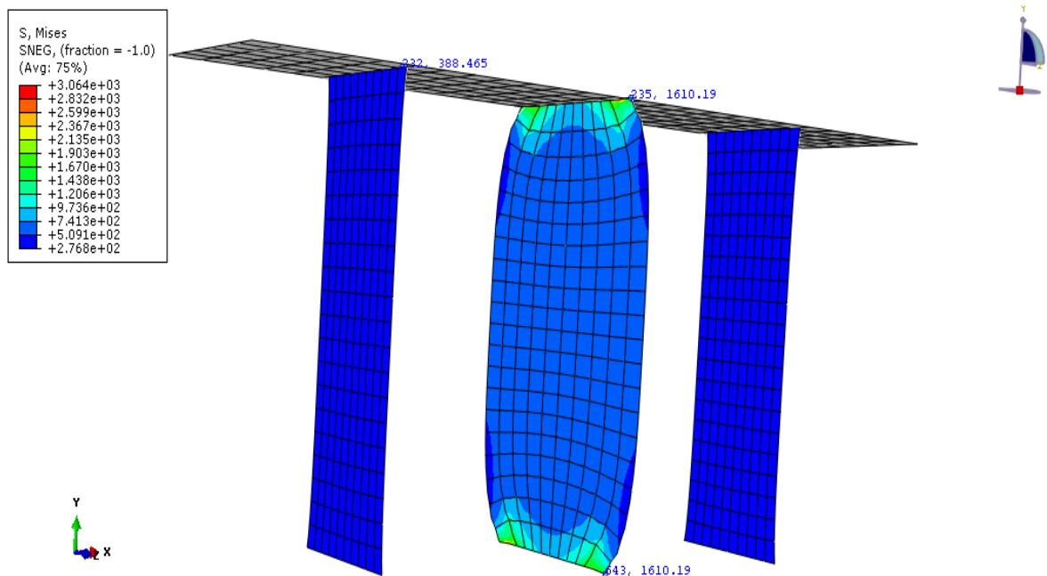
Slika 53: Prikaz rezultata naprezanja za model s 750 elemenata u MPa
