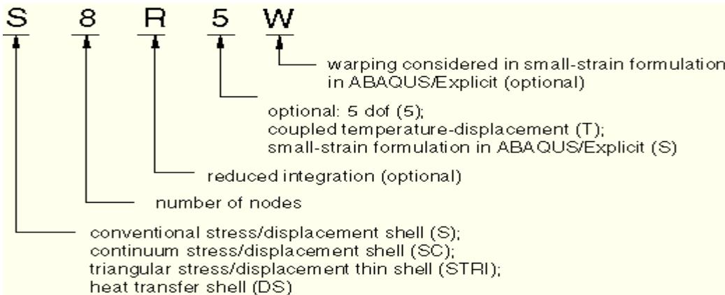
Slika 11: Značenje pojedinog slova elementa S8R5W [1]
