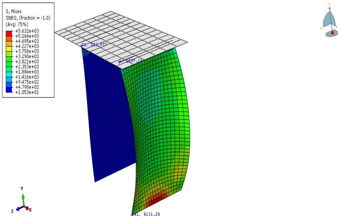
Slika 81 daje prikaz pomaka na modelu od 312 elemenata. Na slici 82 prikazani su pomaci modela diskretiziranog s 750 elemenata. Na slici 83 nalazi se raspodjela pomaka na modelu opisanim s 3000 konačnih elemenata.
