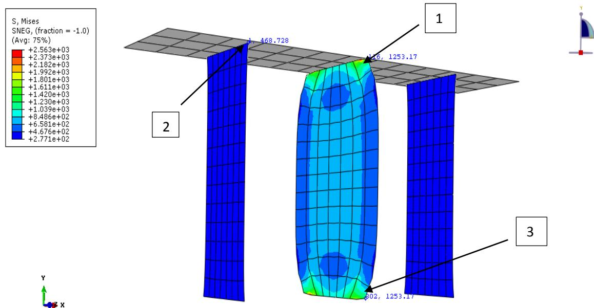
Slika 52: Prikaz rezultata naprezanja za model s 312 elemenata u MPa
