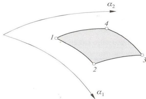
Slika 3: Zakrivljeni element izведен primjenom teorije ljusaka [3]
