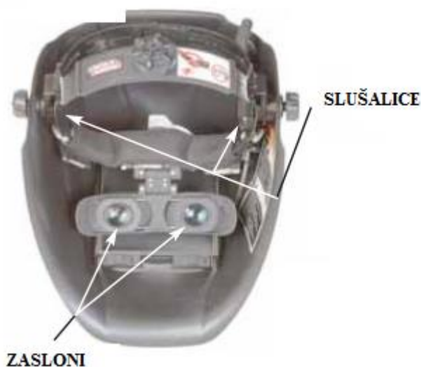
Slika 3.16. 3D maska za virtualno zavarivanje [13].
