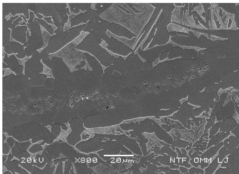
Slika 5.6: Mikrostruktura snimljena elektronskim mikroskopom (povećanje 800x)
