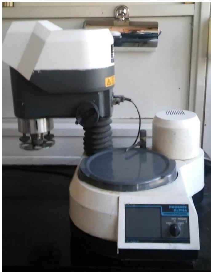
Slika 4.4: Stroj za brušenje
