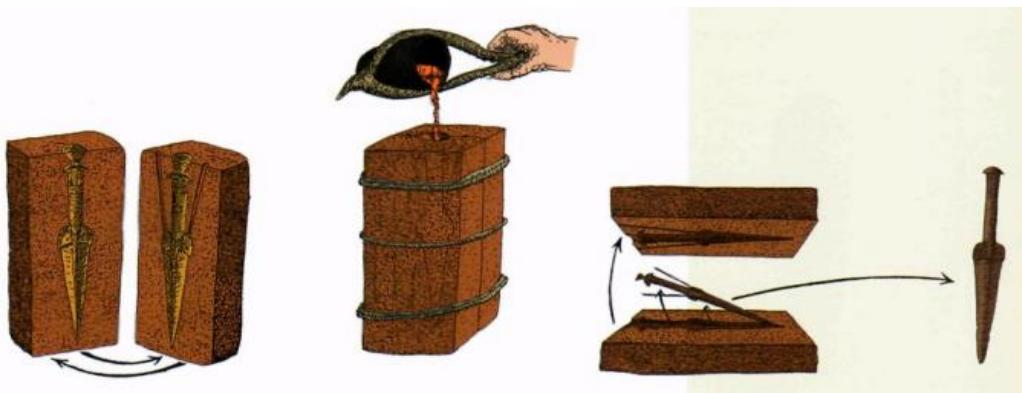
Slika 2.3: Ilustracija lijevanja bodeža u zatvorenom kalupu. [5]
