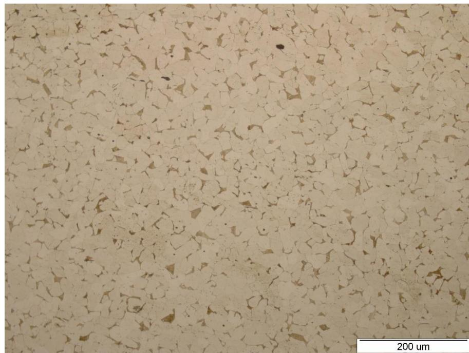
Slika 5.10: Mikrostruktura kutnog L profila ( povećanje 200x)
