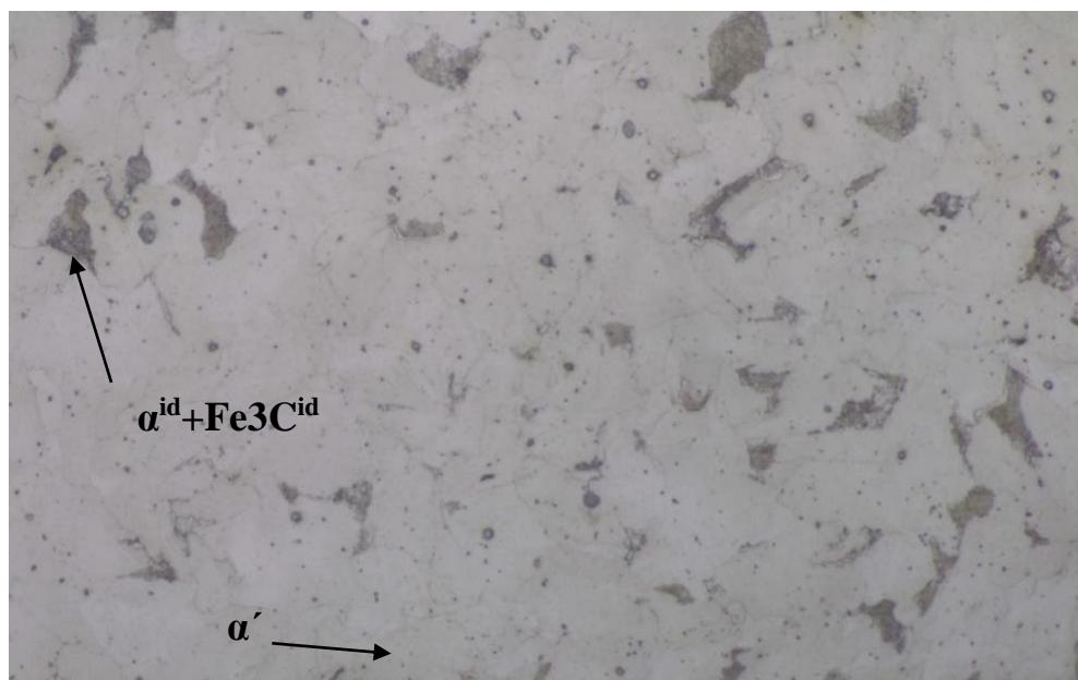
Slika 5.9: Mikrostruktura čavla (povećanje 1000x)
