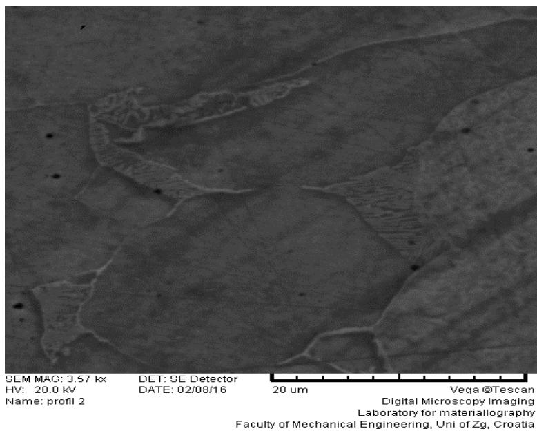
Slika 5.13: Mikrostruktura kutnika L profila snimljena na elektronskom mikroskopu
