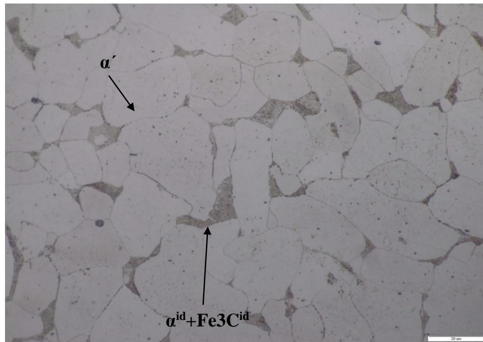
Slika 5.11: Mikrostruktura kutnog L profila (povećanje 1000x)
