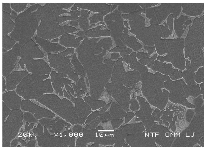
Slika 5.7: Mikrostruktura snimljena elektronskim mikroskopom (povećanje 1000x)
