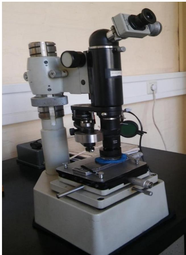
Slika 4.9: Uređaj za ispitivanje mikrotvrdoće
