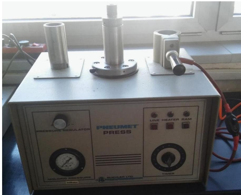
Slika 4.3: Uređaj za izradu kalupa
