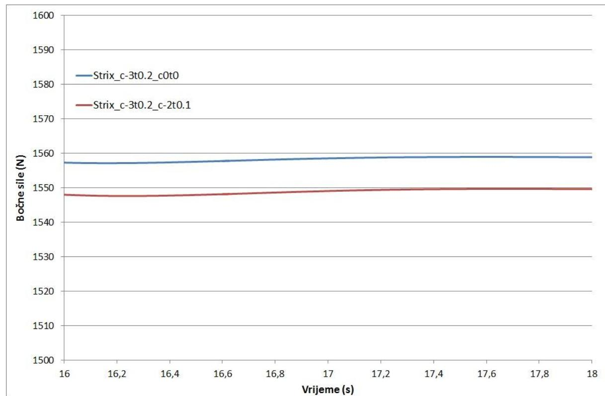
**Slika 47. Usporedba bočnih sila na prednjem desnom kotaču**
