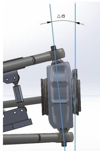
**Slika 26. Promjenjivi kut bočnog nagiba osi zakreta kotača**
