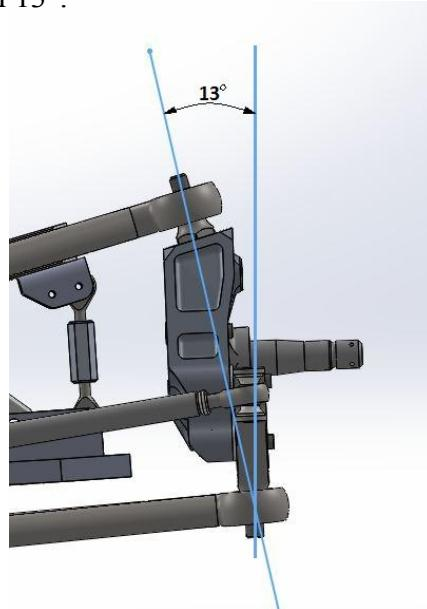
**Slika 20. Vrijednost bočnog nagiba osi zakreta kotača**
