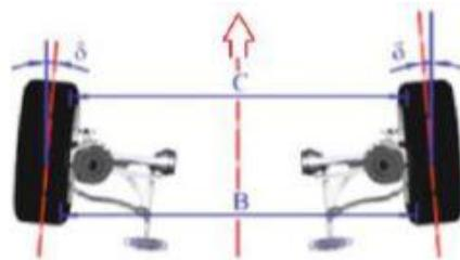
**Slika 7. Usmjerenost kotača [1]**
