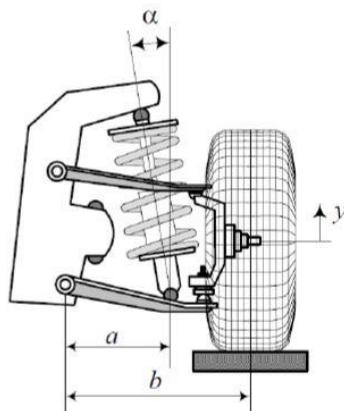
Slika 15. Ovjes s dvostrukim poprečnim ramenima [3]
