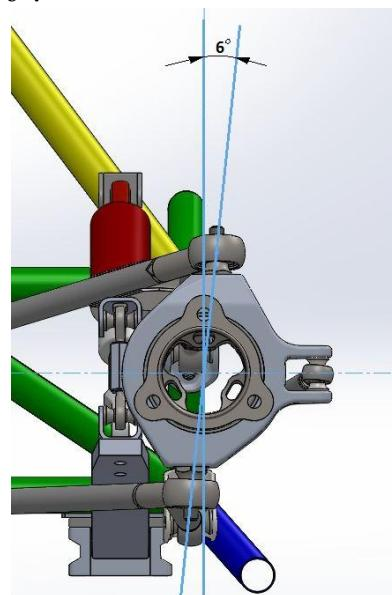
**Slika 27. Vrijednost uzdužnog nagiba osi zakreta kotača**
