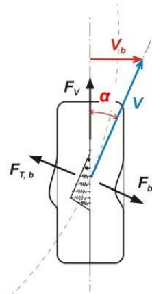
**Slika 13. Kut bočnog klizanja [2]**
