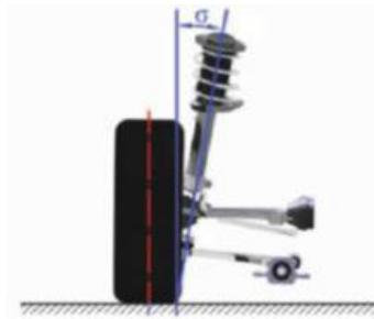
**Slika 6. Bočni nagib osi zakreta kotača [1]**
