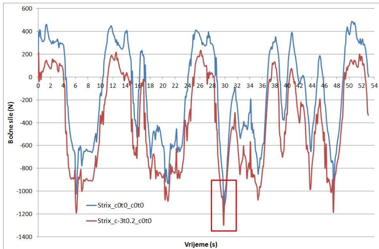
**Slika 51. Bočne sile na prednjem lijevom kotaču-usporedba**
