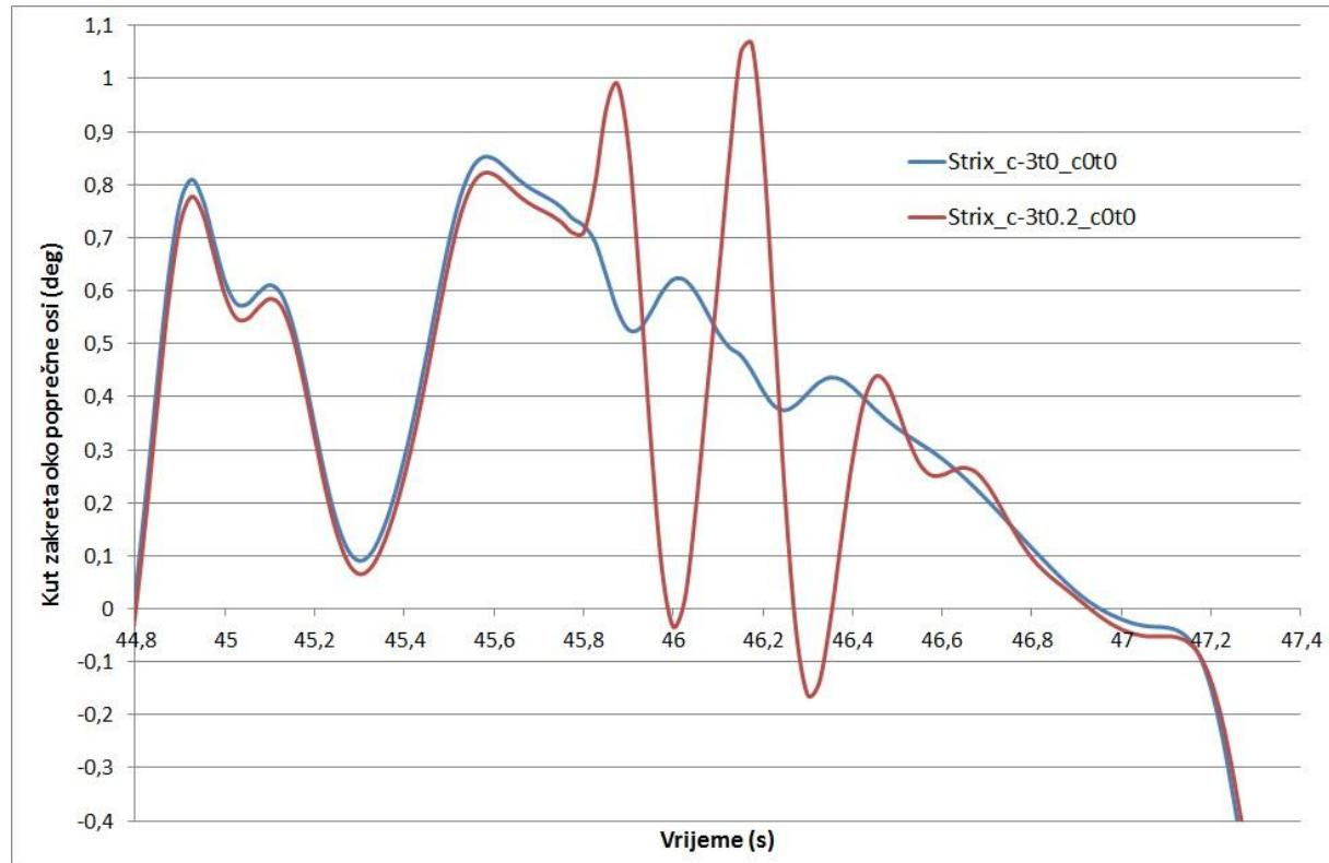
Slika 54. Kut zakreta bolida oko poprečne osi - usporedba
