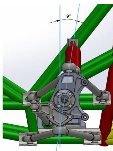
**Slika 21. Vrijednost uzdužnog nagiba osi zakreta kotača**
