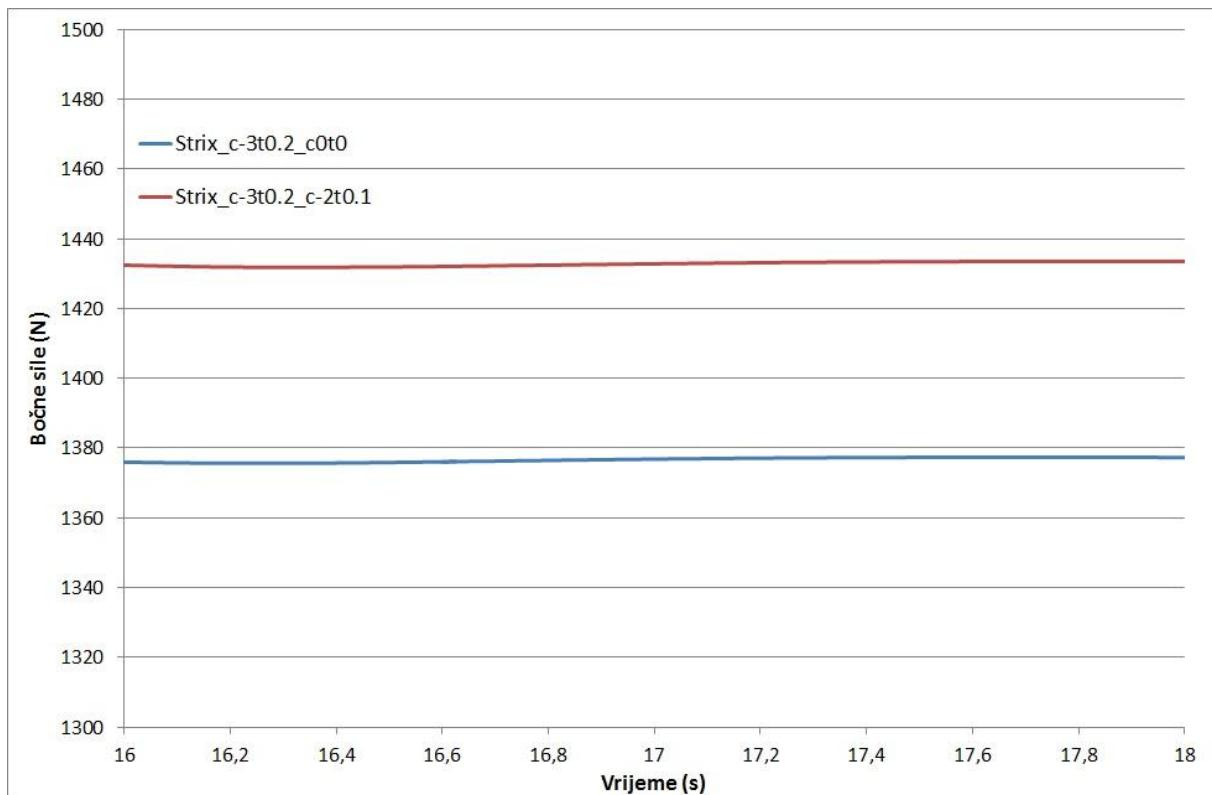
**Slika 48. Usporedba bočnih sila na stražnjem desnom kotaču**
