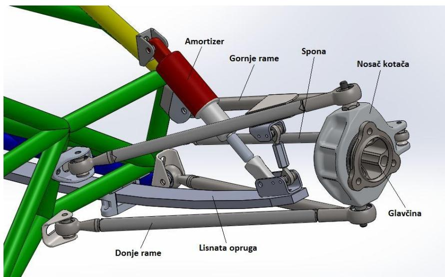
**Slika 23. Konstrukcijsko rješenje stražnjeg ovjesa na bolidu Strix**
