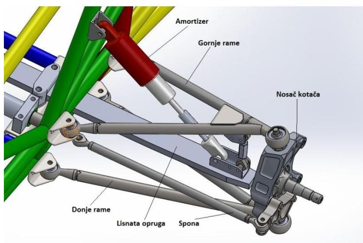
Slika 16. Konstrukcijsko rješenje ovjesa na bolidu Strix
