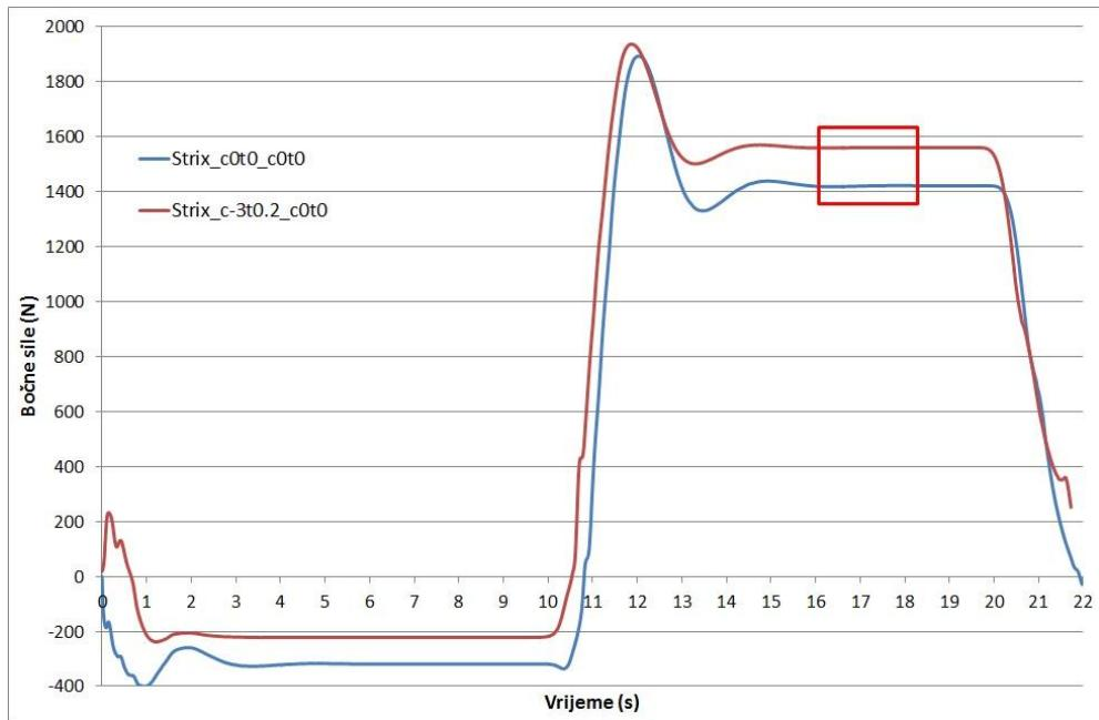
Slika 44. Bočne sile na prednjem desnom kotaču - usporedba
