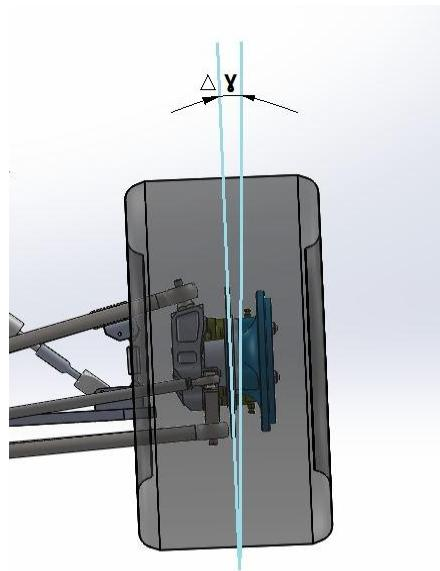
**Slika 19. Promjenjivi kut bočnog nagiba kotača**
