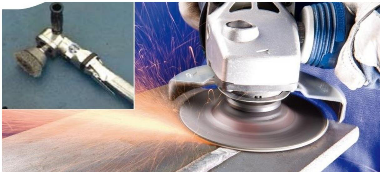
Slika 13. Brušenje i rotacijska četka[17,19]
