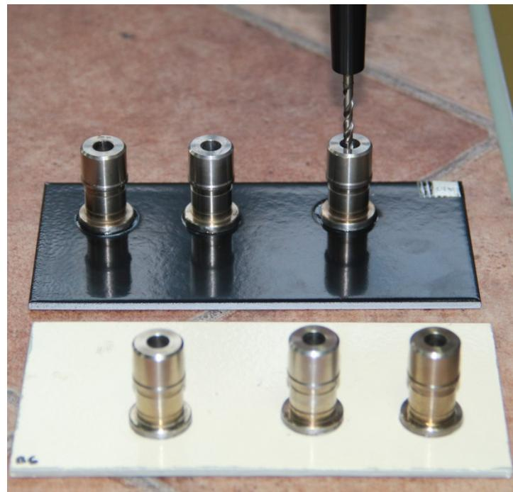
**Slika 26. Uklanjanje viška ljepila iz sredine valjčića odvijačem**
