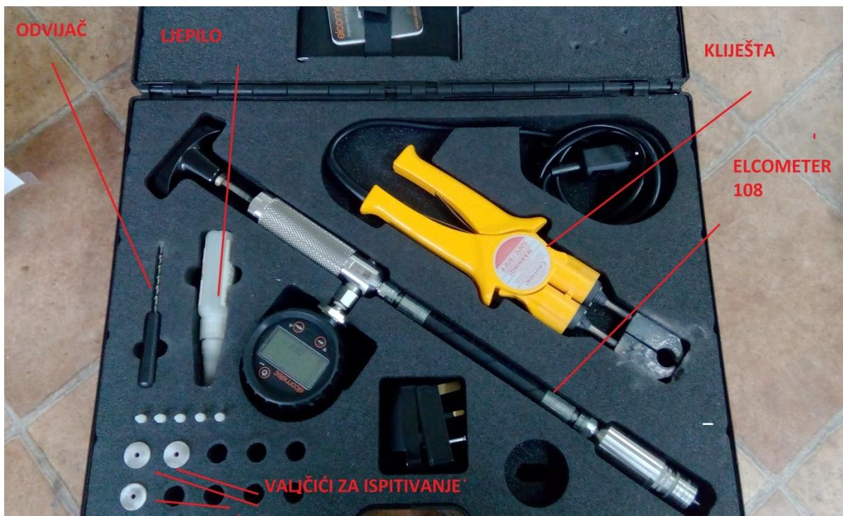
**Slika 25. Oprema za pull-off test**
