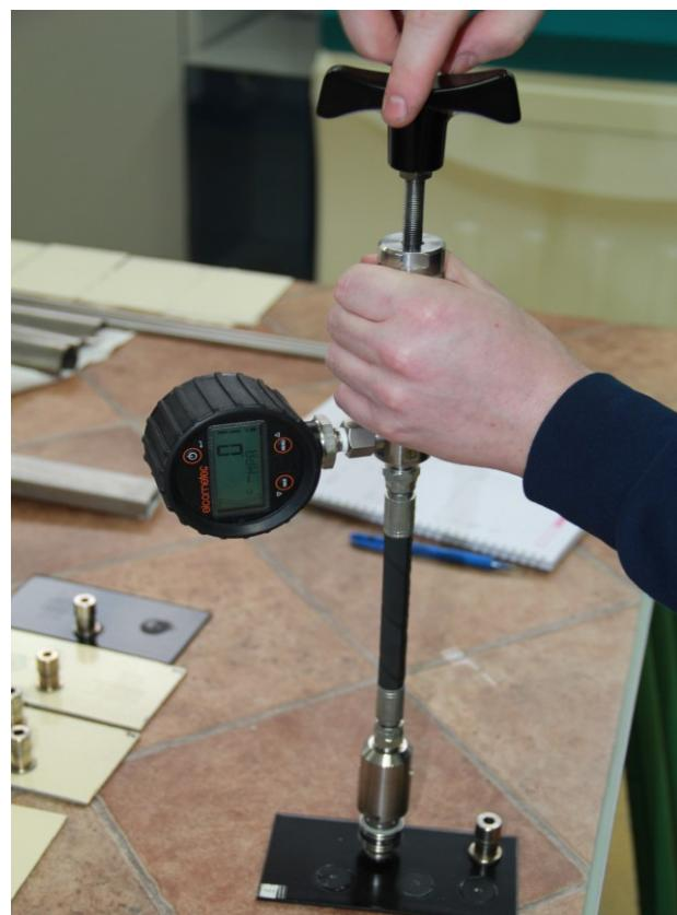
**Slika 27. Ispitivanje prionjivosti premaza**
