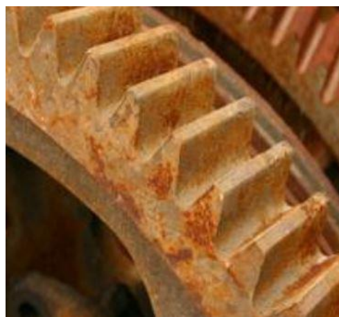
Slika 3. Opća korozija zupčanika [5]
