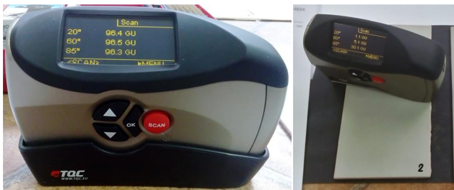
Slika 16. Instrument i postupak mjerenja sjaja [14]
