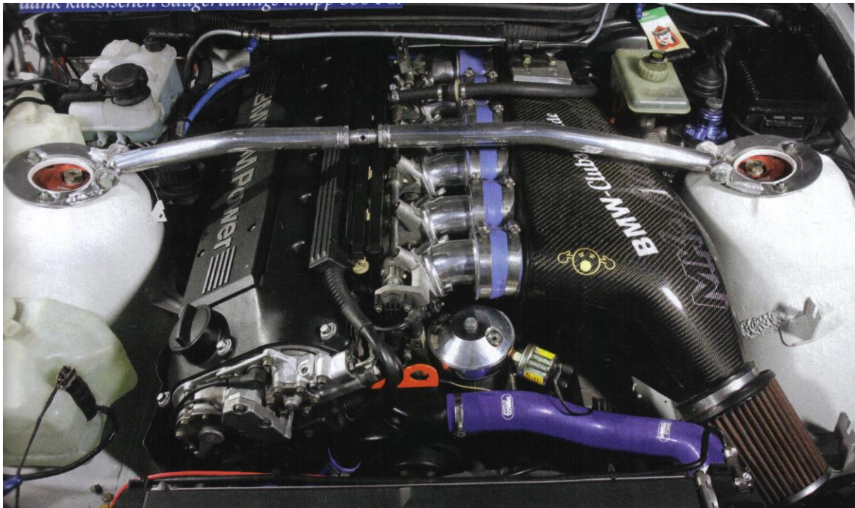
Slika 43 Ugrađen motor s prednjim povezičaćem unutrašnjih blatobrana ( e. strut bar )
