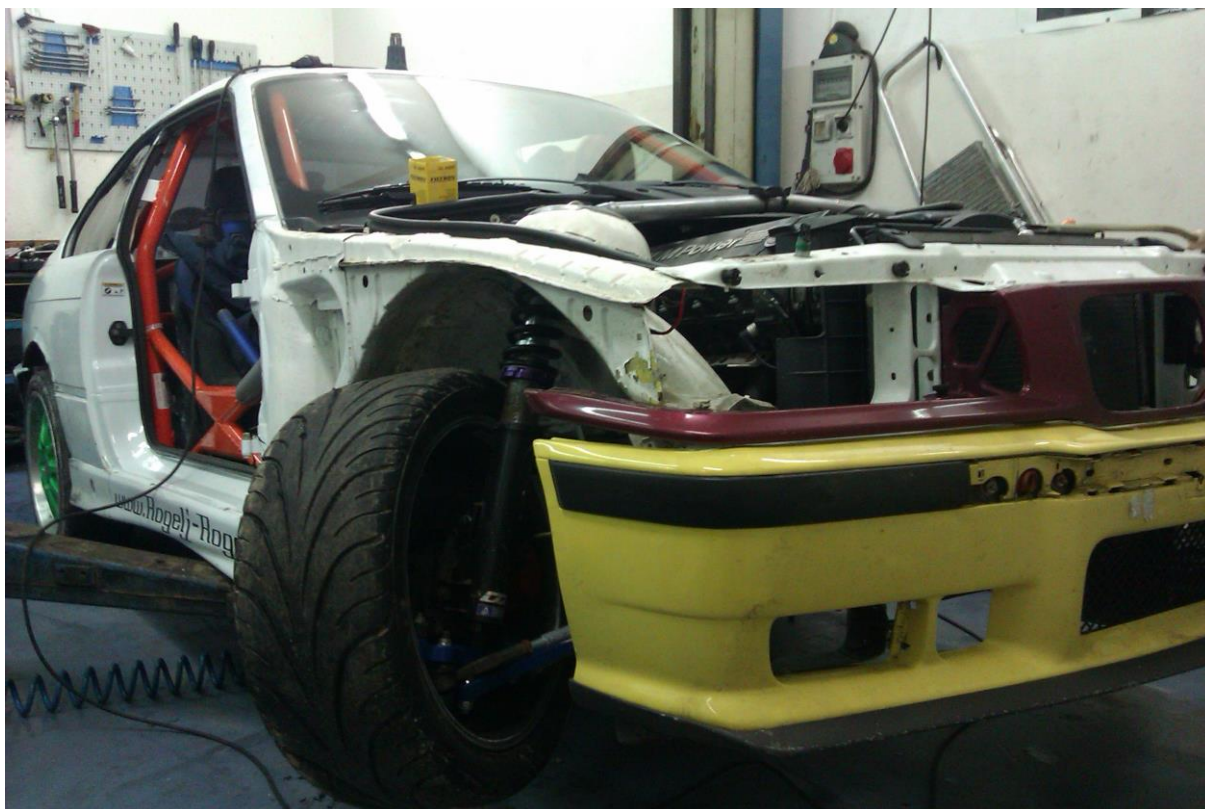
Slika 95 Kut od 60 stupnjeva zakreta prednjih kotača
