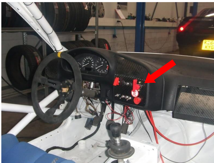
Slika 37 Unutrašnjost automobila sa prekidačem za isključivanje struje
