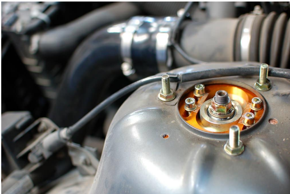
Slika 87 Podešavanje bočnog kuta
