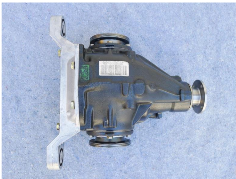
Slika 54 Samoblokirajući diferencijal u kućištu 210
