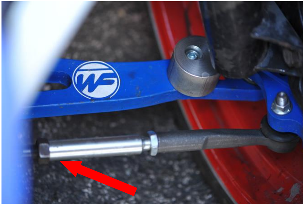
Slika 89 Podešavanje usmjerenosti kotača
