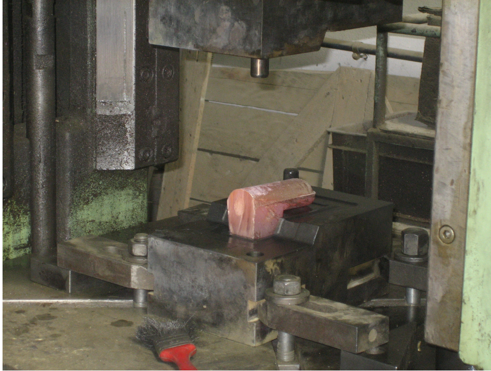
Slika 24. Odljevak u ukovnju
