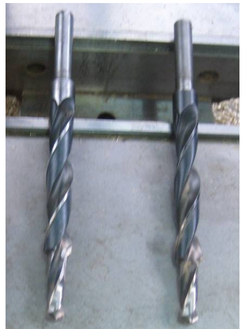
Slika 37. Svrdla s dvostrukim promjerima
