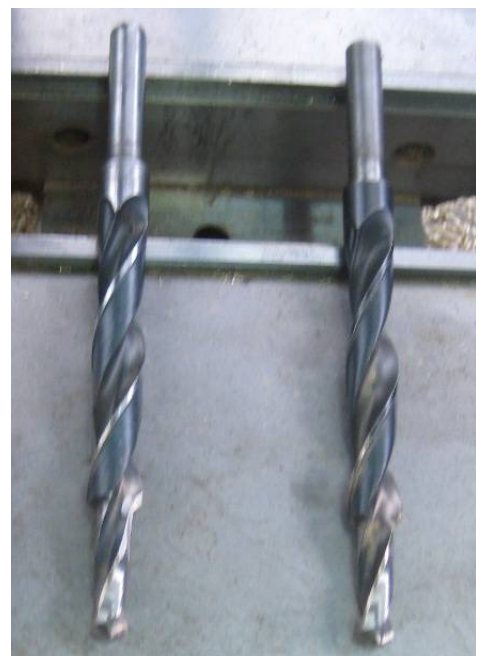
Slika 37. Svrdla s dvostrukim promjerima
