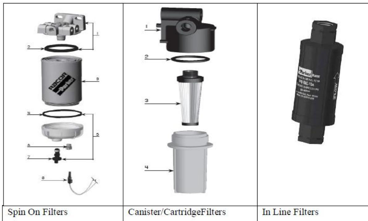
Slika 18. Usporedba filtera prema strukturi
