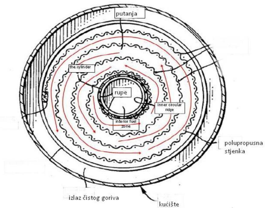
**Slika 22. Polupropusni separator vode**
