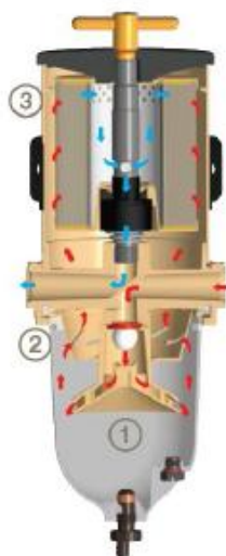
Slika 23. Turbinski filter i separator
