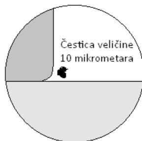
Slika 1. Čestica veličine 10 mikrometara zarobljena na spoju pokretnih dijelova
