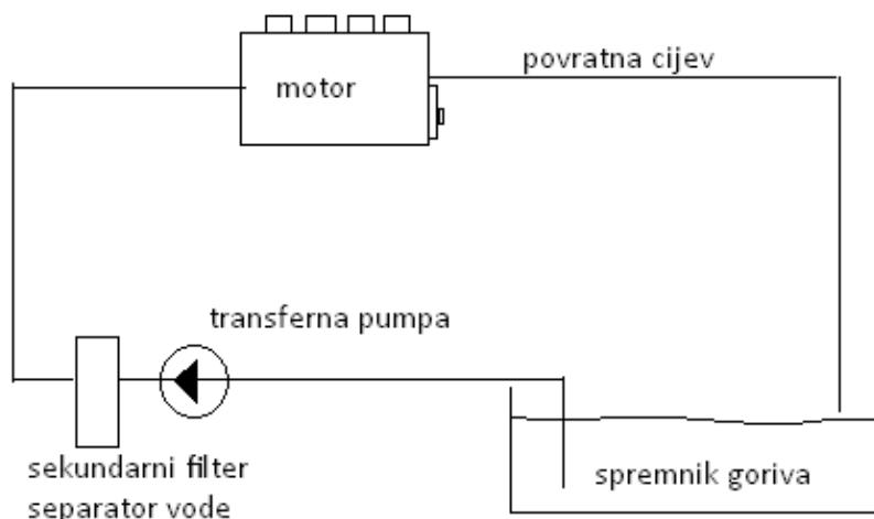
**Slika 15. Sistem dovoda sa filterom na strani pretlaka**
