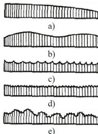
Slika 16: Osnovne vrste odstupanja površine: a) neparalelnost, b) valovitost, c) izbrazdanost, d) hrapavost, e) rezultantna realna površina [15].
