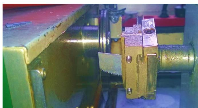
Slika 22: Prikaz postupka izrezivanja dijela uzorka pile.
