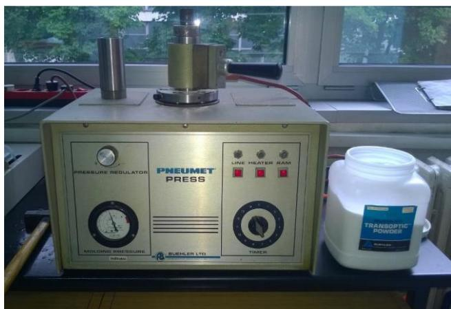
Slika 23: Prikaz uređaja za kapsuliranje
