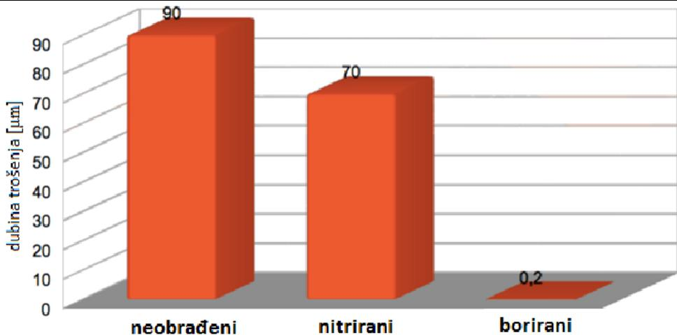
Slika 1: Usporedba trošenja neobrađenih, nitriranih i boriranih čelika.
