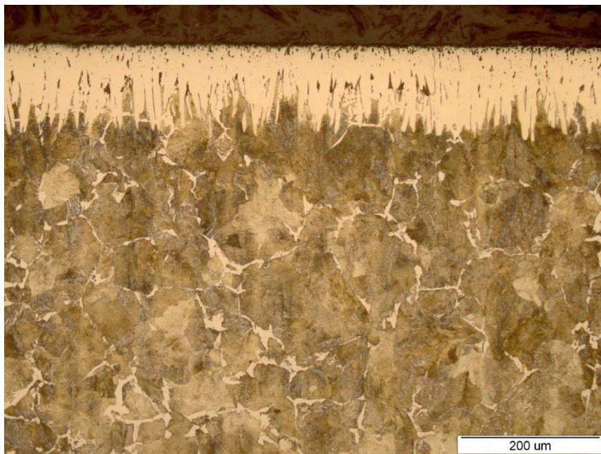
Slika 25: Mikrostruktura boridnog sloja C45, povećanje 200x
