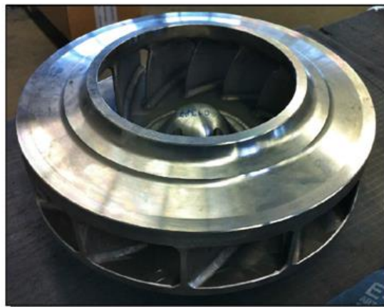
Slika 4: Borirani dio pumpe
