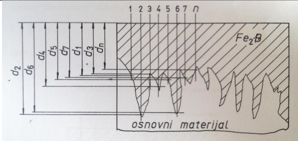
Slika 21: Princip mjerena dubine boridnog sloja metalografskom metodom
