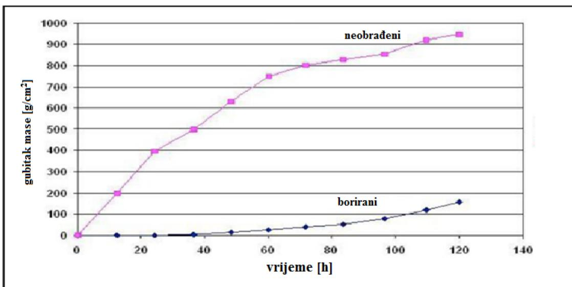
Slika 2: Korozija visoko legiranih čelika u rastaljenom cinku.
