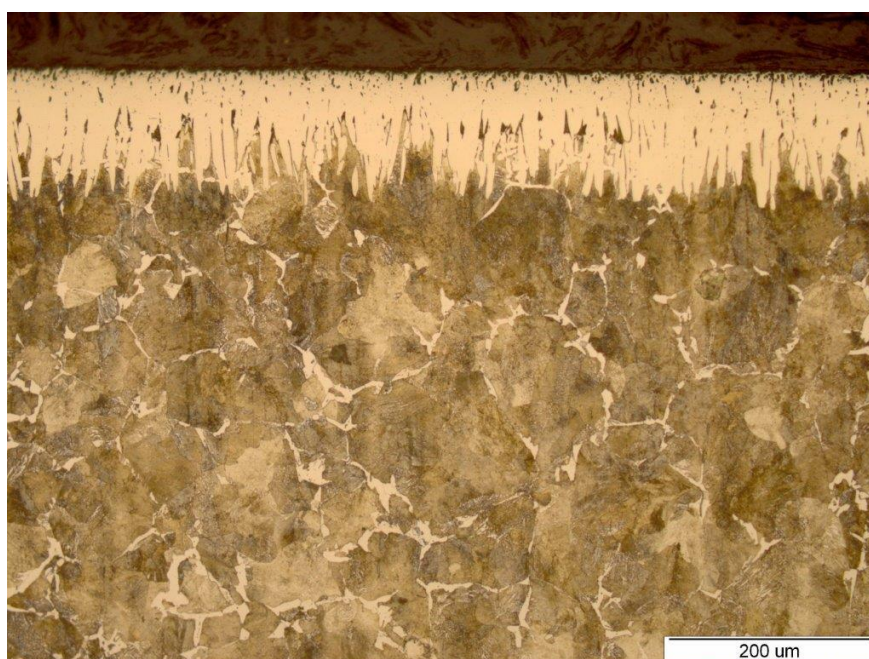
Slika 25: Mikrostruktura boridnog sloja C45, povećanje 200x
