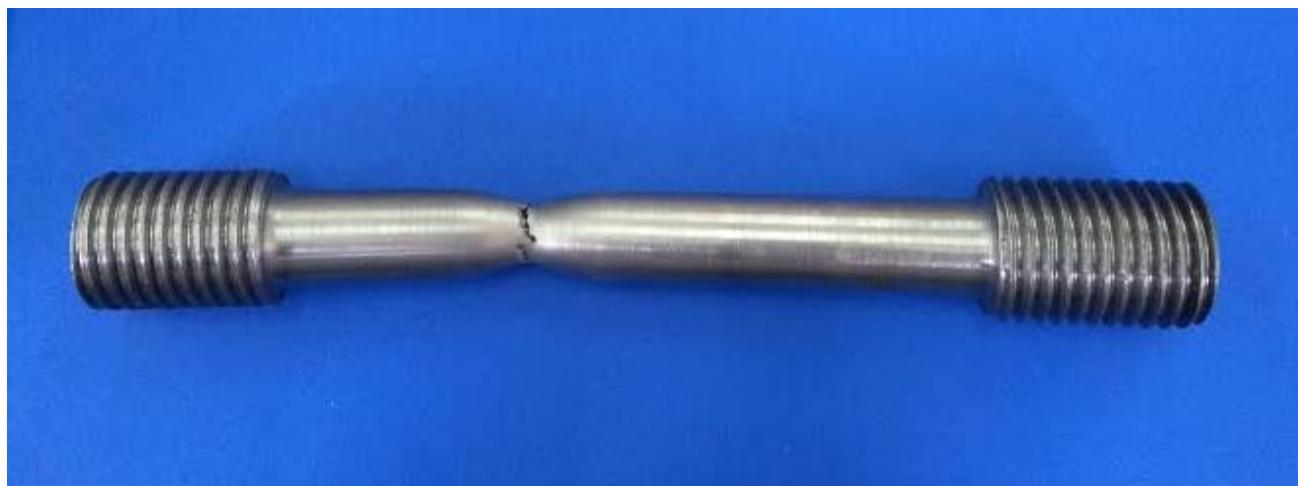
Slika 39. Epruveta nakon statičkog vlačnog ispitivanja
