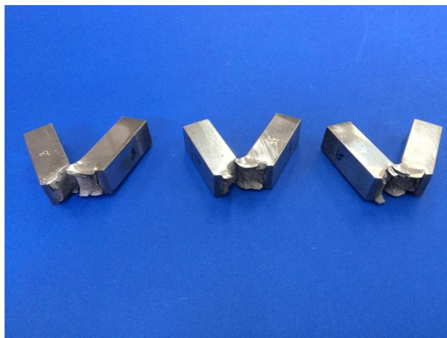
**Slika 42. Epruvete nakon provedenog ispitivanja**
