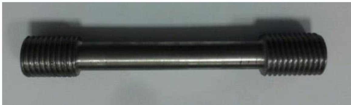
**Slika 37. Epruveta za statičko vlačno ispitivanje**
