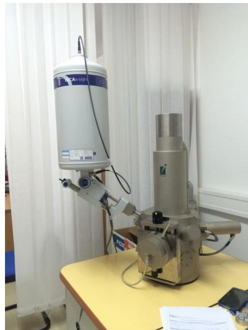
**Slika 31. Skenirajući elektronski mikroskop (SEM) Tescan Vega TS5136LS**
