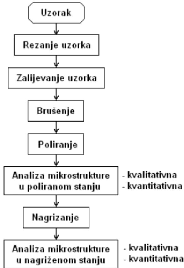
**Slika 8. Shema pripreme i ispitivanja uzorka**
