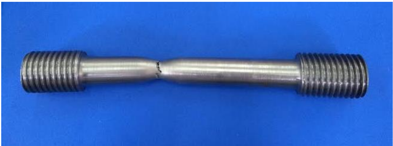
Slika 39. Epruveta nakon statičkog vlačnog ispitivanja
