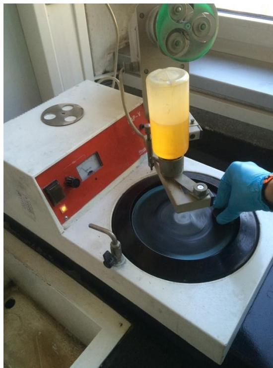
**Slika 24. Poliranje uzorka**
