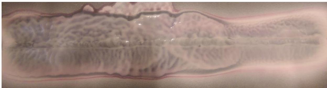
Slika 23. Ispitivanje korjena zavora penetrantima - sušenje razvijlača
