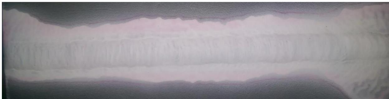
Slika 24. Ispitivanje lica zavora penetrantima - osušen razvijlač
