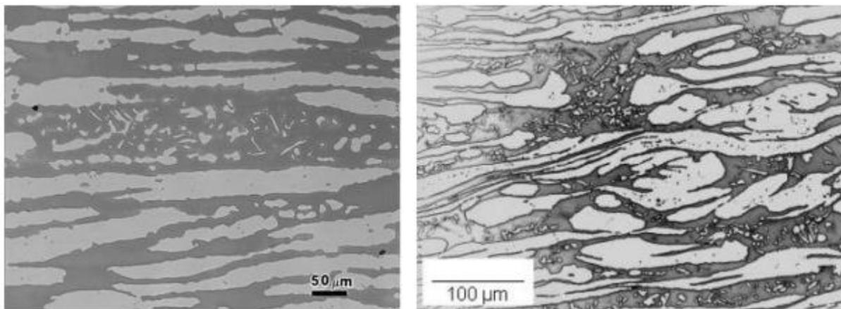
Slika 4. Mikrostruktura austenitno-feritnih (dupleks) nehrđajućih čelika [1]
