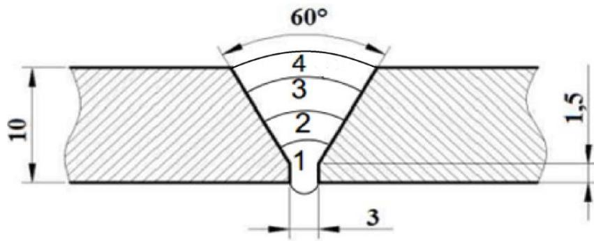
Slika 19. Shematski prikaz slaganja prolaza prilikom zavarivanja
