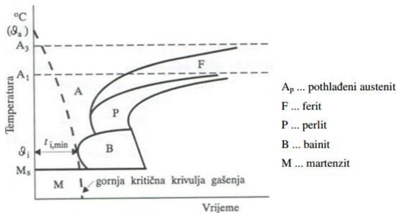
Slika 8. Shematski prikaz utvrđivanja gornje kritične brzine gašenja [4]
