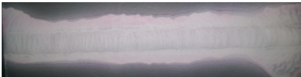
Slika 24. Ispitivanje lica zavora penetrantima - osušen razvijlač
