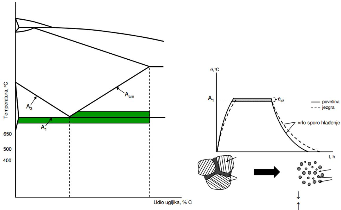
Slika 6. Sferoidizacijsko žarenje [4]
