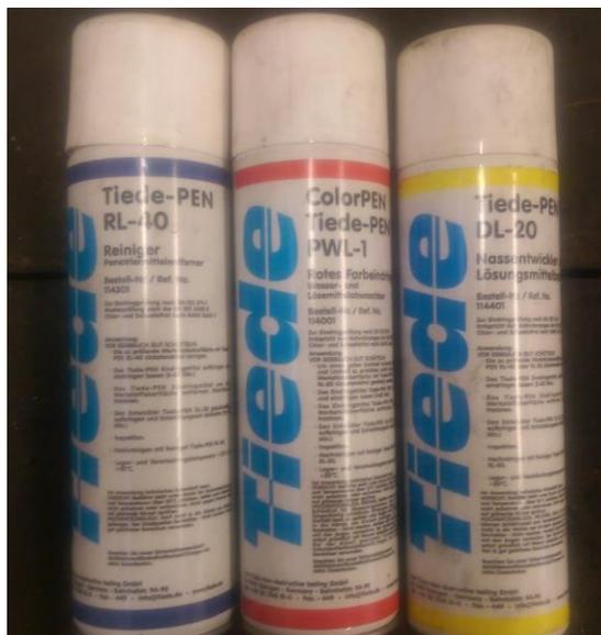
Slika 22. Korištena sredstva: čistač, penetrant, razvijlač
