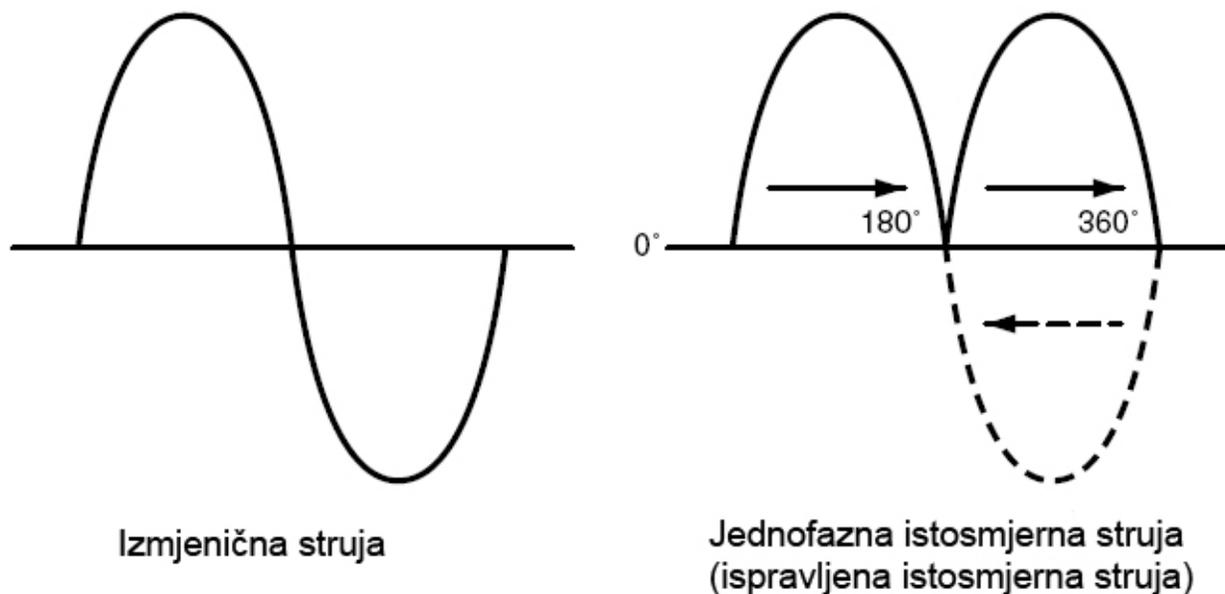
Slika 12. Izmjenična i istosmjerna struja [7]
