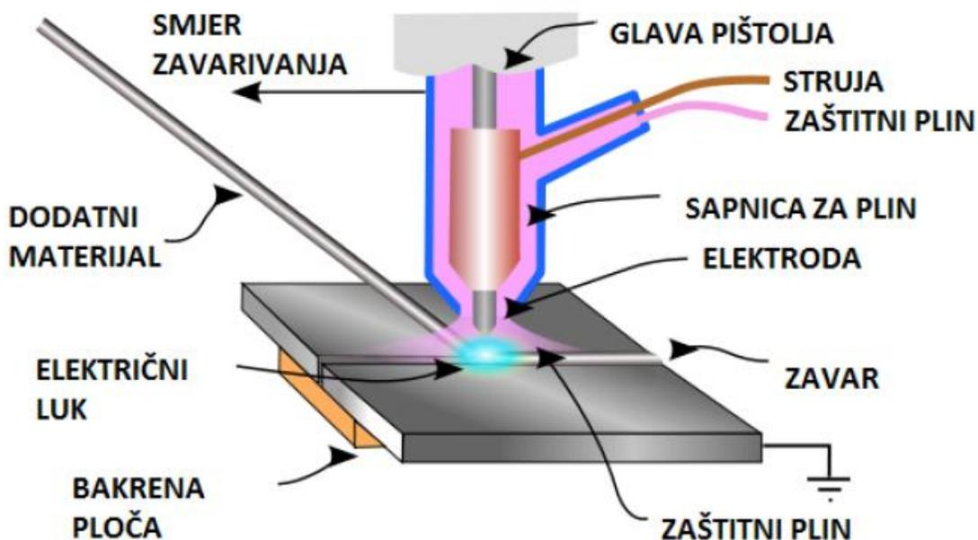
Slika 16. Shematski prikaz TIG postupka zavarivanja [6]
