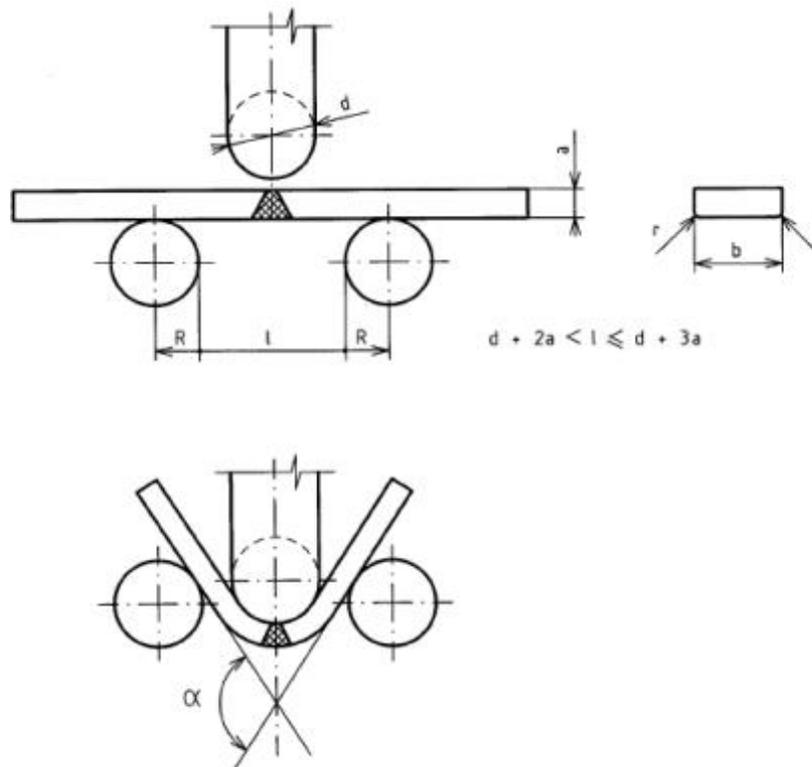
Slika 27. Postupak savijanja
