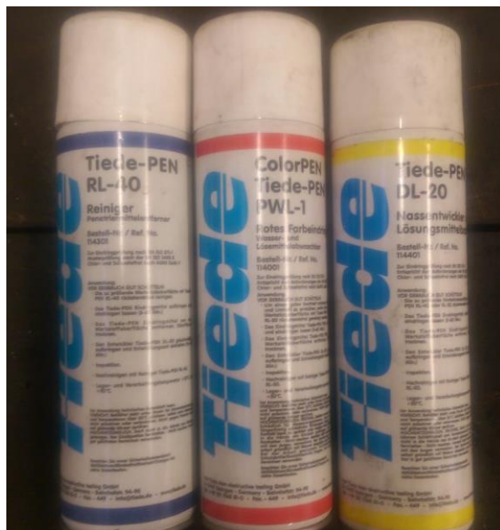
Slika 22. Korištena sredstva: čistač, penetrant, razvijlač
