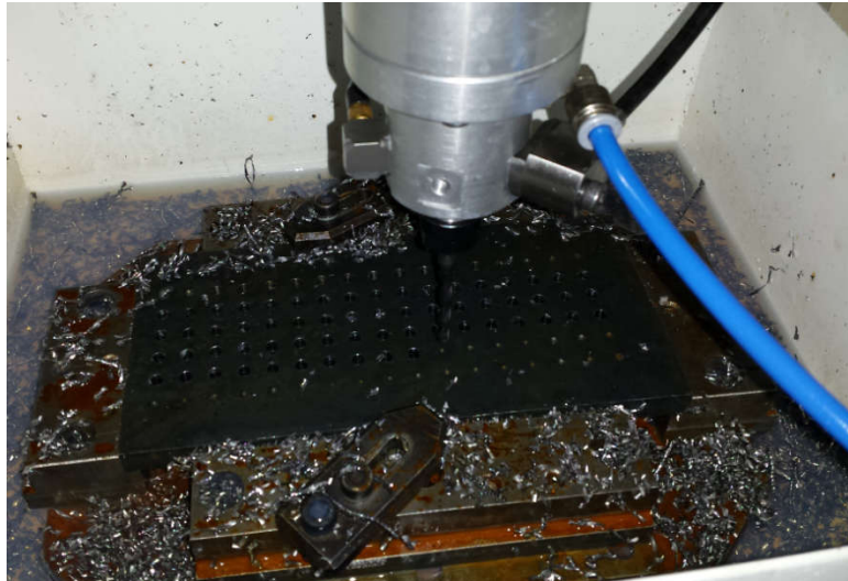
Slika 53. Prikaz stegnutog obratka za vrijeme obrade
