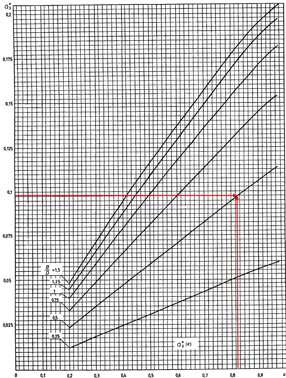
Slika 7: Graf parametra Q_3^* kao funkcija relativnog ekscentriciteta \epsilon za \Omega = 360^\circ [2]
