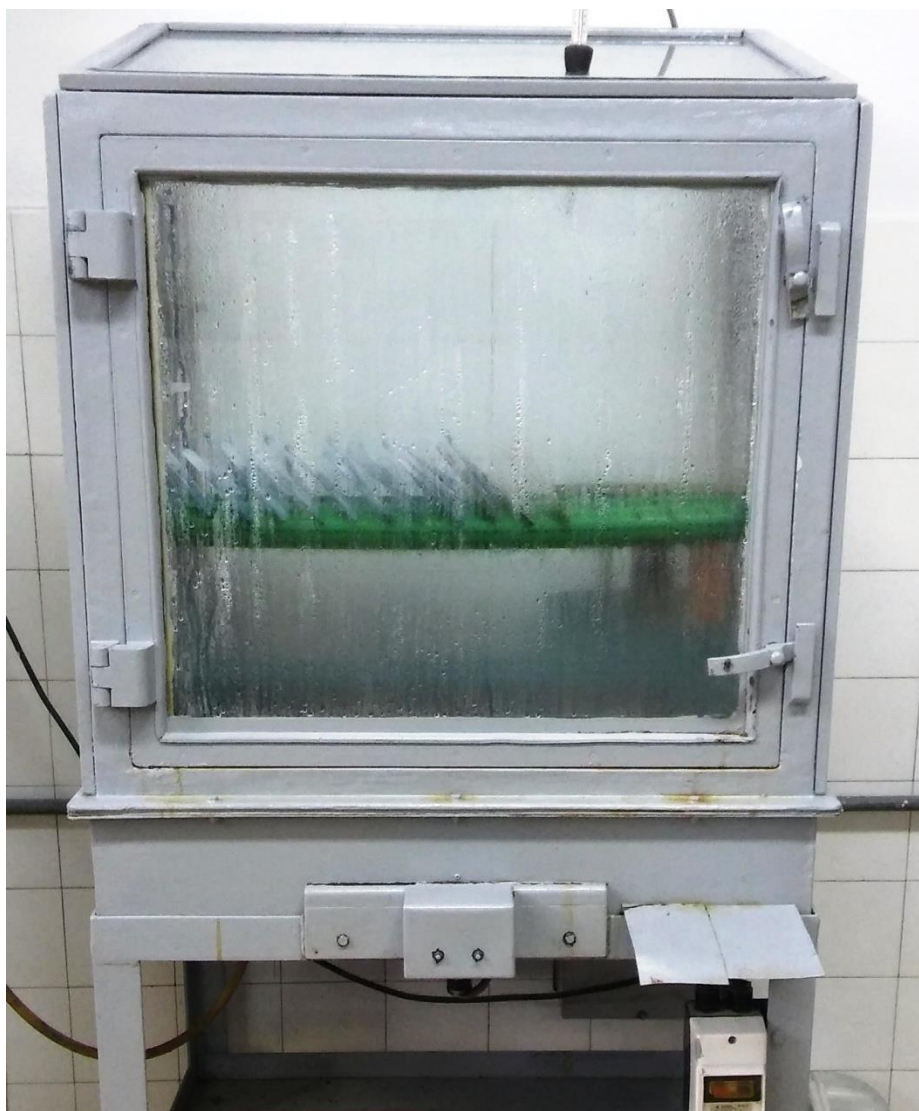
Slika 15. Vlažna komora, Laboratorij za zaštitu materijala
