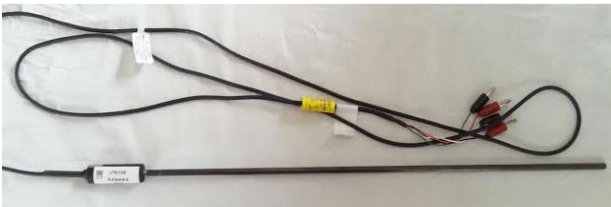
Slika 9. Termometar korišten za mjerenje temperature peći
