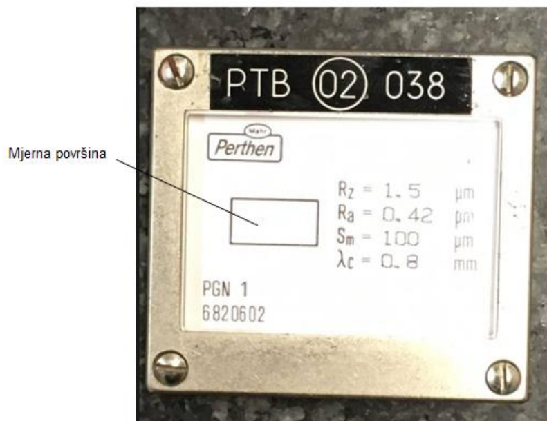
Slika 37. Referentni državni etalon za hrapavost Perthen
