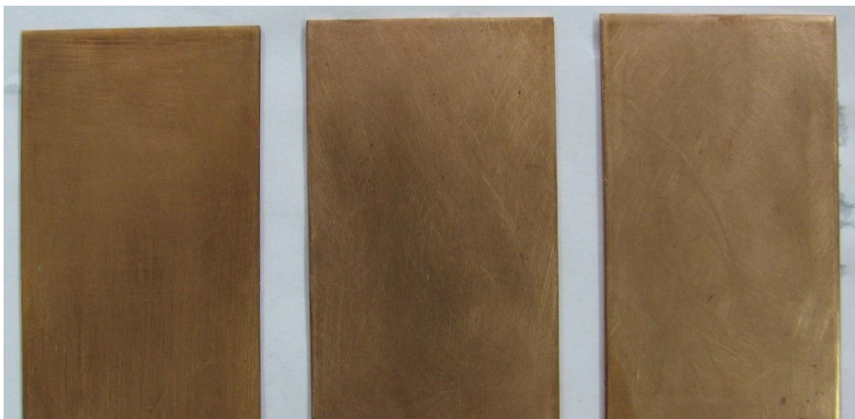
Slika 23. Rezultati ispitivanja uzoraka od bakra PE folijom debljine 100 \mu\text{m} u slanoj komori
