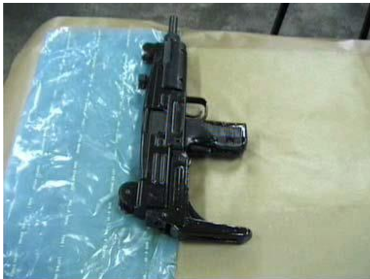
Slika 11. Primjena hlapljivih inhibitora korozije za zaštitu oružja [20]
