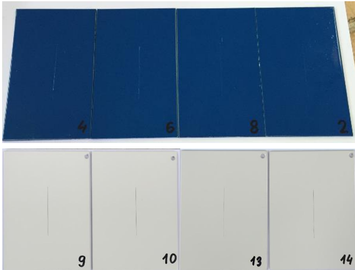
Slika 29. Uzorci s napravljenim oštećenjima
