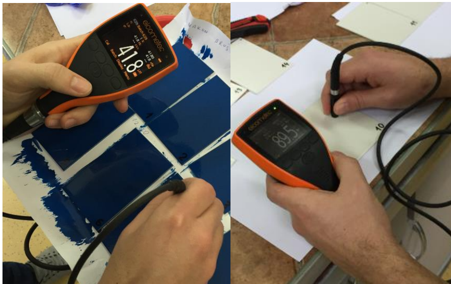
Slika 27. Mjerenje debljine prevlake
