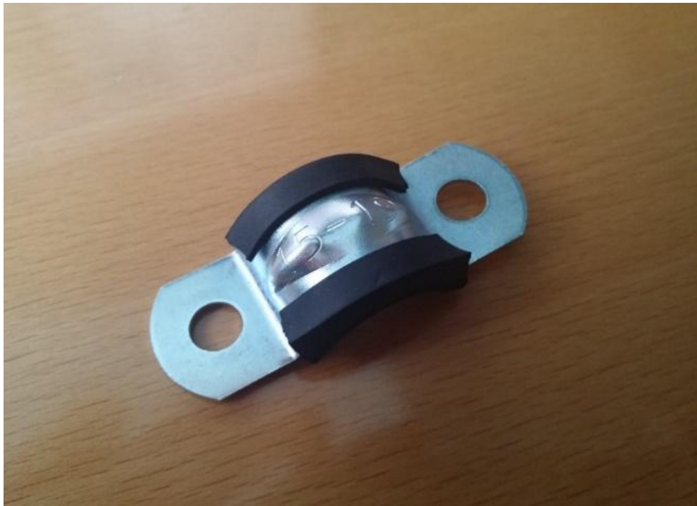
Slika 7. Poluobujmica SRSŽ 15-19 nakon cinčanja i s navučenom gumenom oblogom
