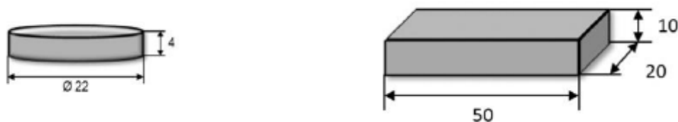
Slika 22. Oblik i dimenzije uzoraka za ispitivanje [16]
