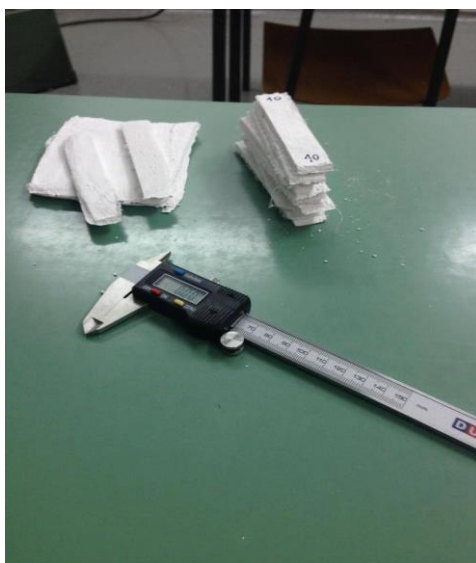
Slika 21. Mjerenje dimenzija ispitnih epruveta
