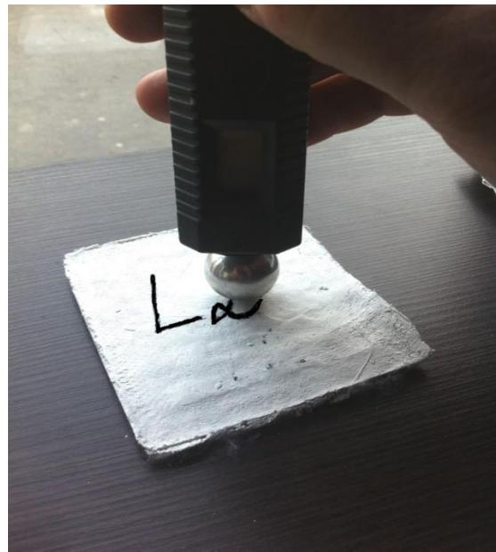
**Slika 12.** Mjerenje vlažnosti sadrene pločice [22]
