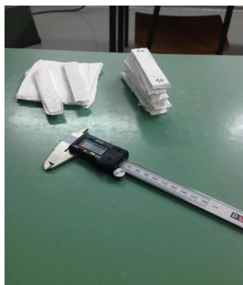
Slika 21. Mjerenje dimenzija ispitnih epruveta
