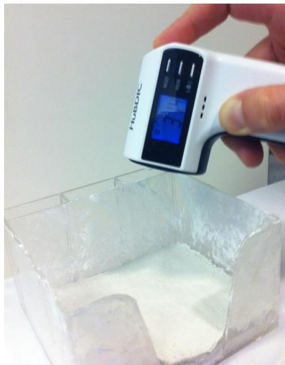
**Slika 14.** Mjerenje površinske temperature [12]
