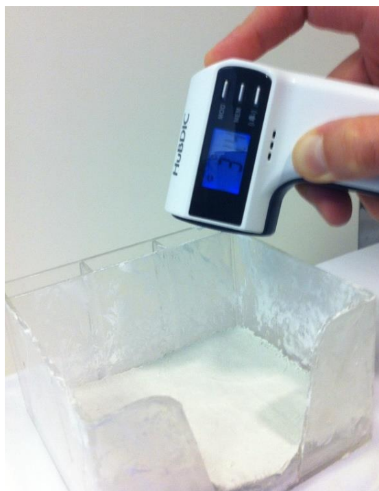
Slika 14. Mjerenje površinske temperature [12]
