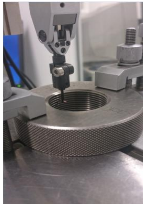
Slika 14. Mjerenje kontrolnog prstena s T-ticalom
