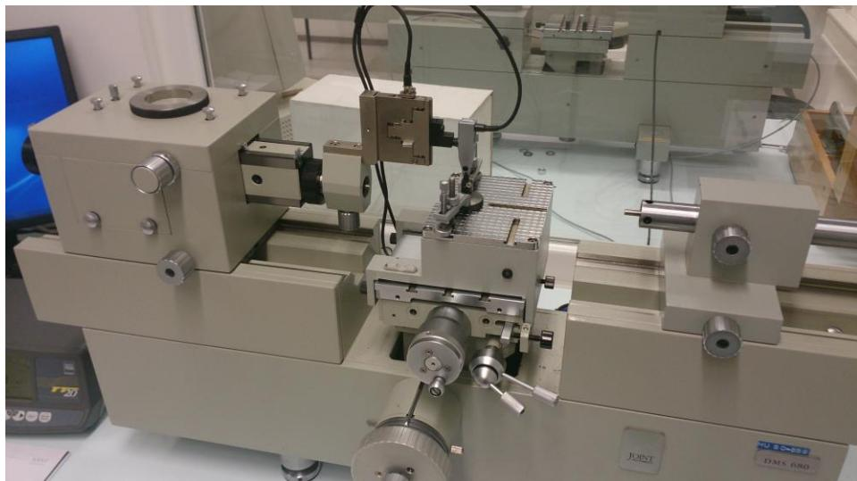
Slika 12. Uređaj za provedbu mjerenja metodom s T-ticalom
