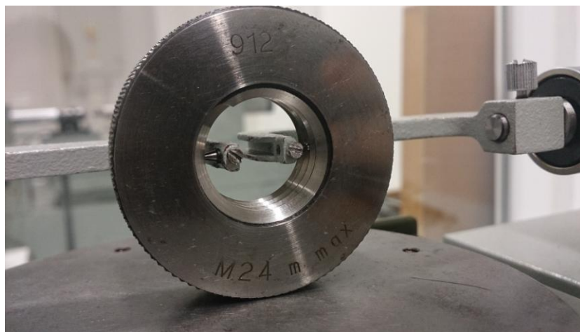
Slika 18. Mjerenje metodom s mjernim čeljustima
