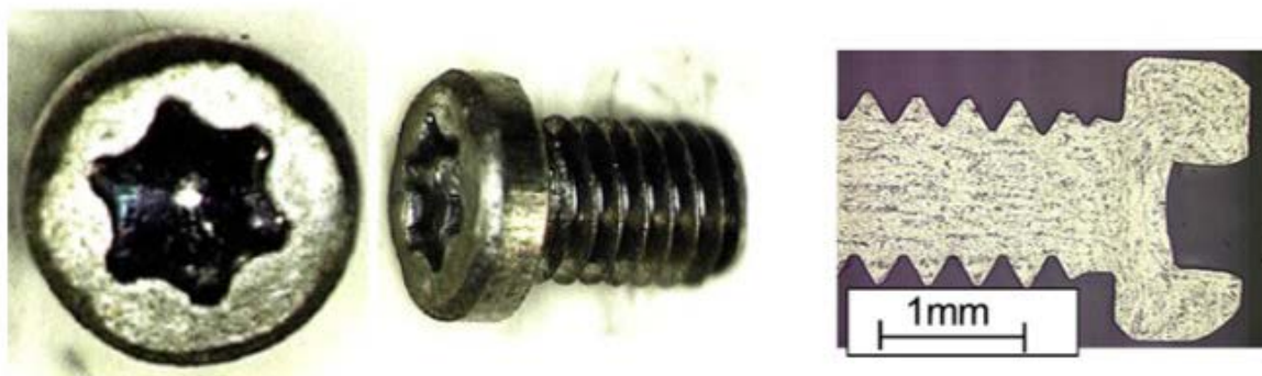
Slika 7. Vijci primijenjeni u dentalnoj medicini izrađeni ECAP-om [4]
