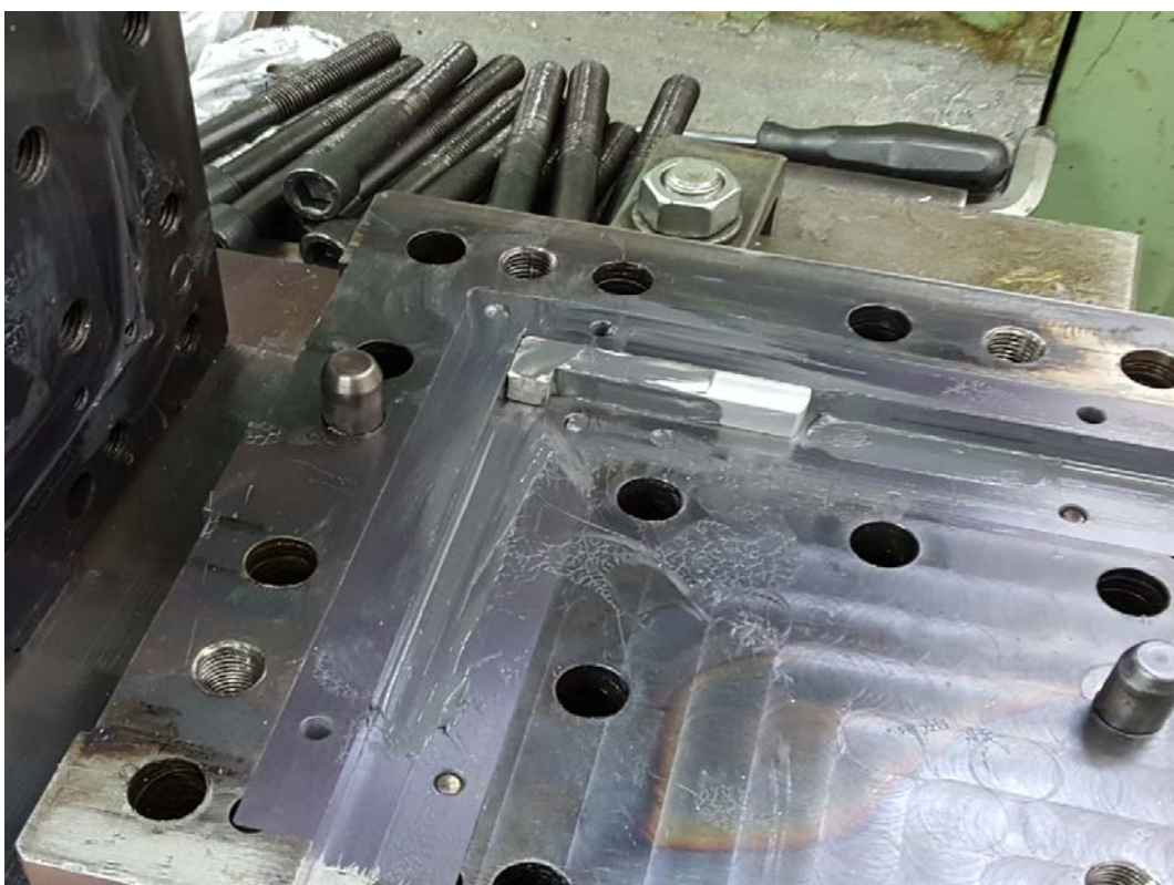
Slika 27. Postavljeni uzorak zakrenut po B_c ruti u kalupu
