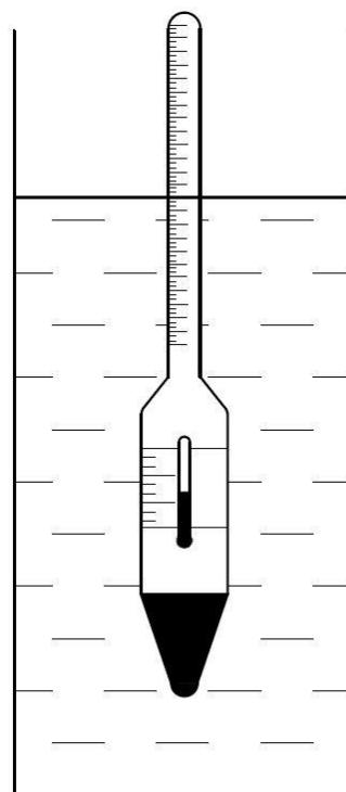
Slika 6.1 Aerometar prema ASTM D1298 normi prema [8]
