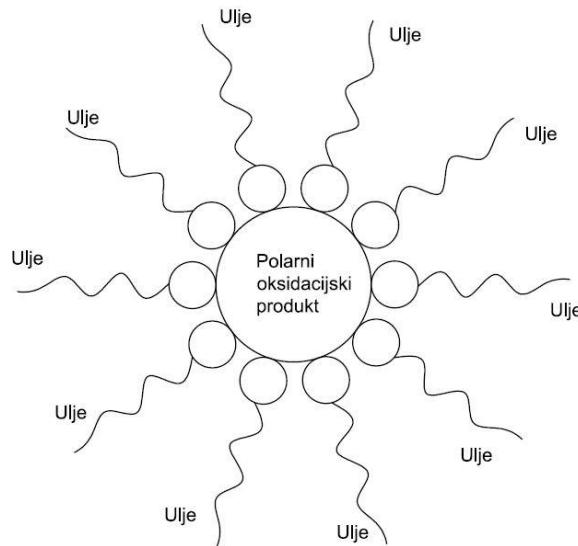
*Slika 3.1 Uljna suspenzija polarne oksidacije prema slici u [5]*
