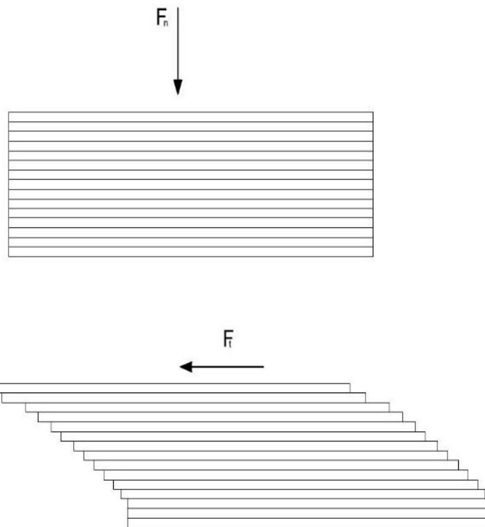
Slika 3.5 Paralelno opterećenje grafitove rešetke prema [5]
