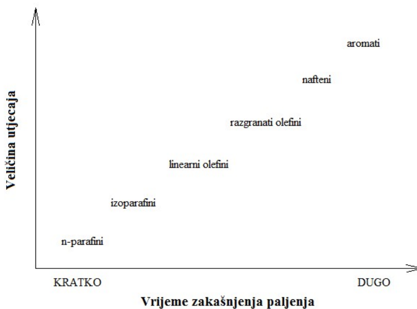
Dijagram 3. Utjecaj frakcija na zakašnjenje paljenja u dizelskom motoru [9]
