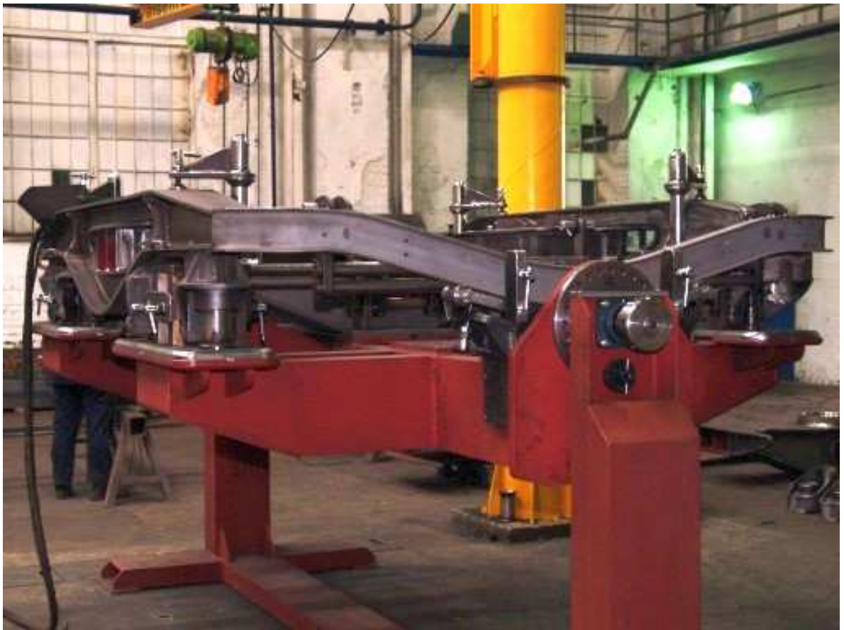
Slika 1. Naprava za zavarivanje okvira okretnog postolja tvornice Gredelj
