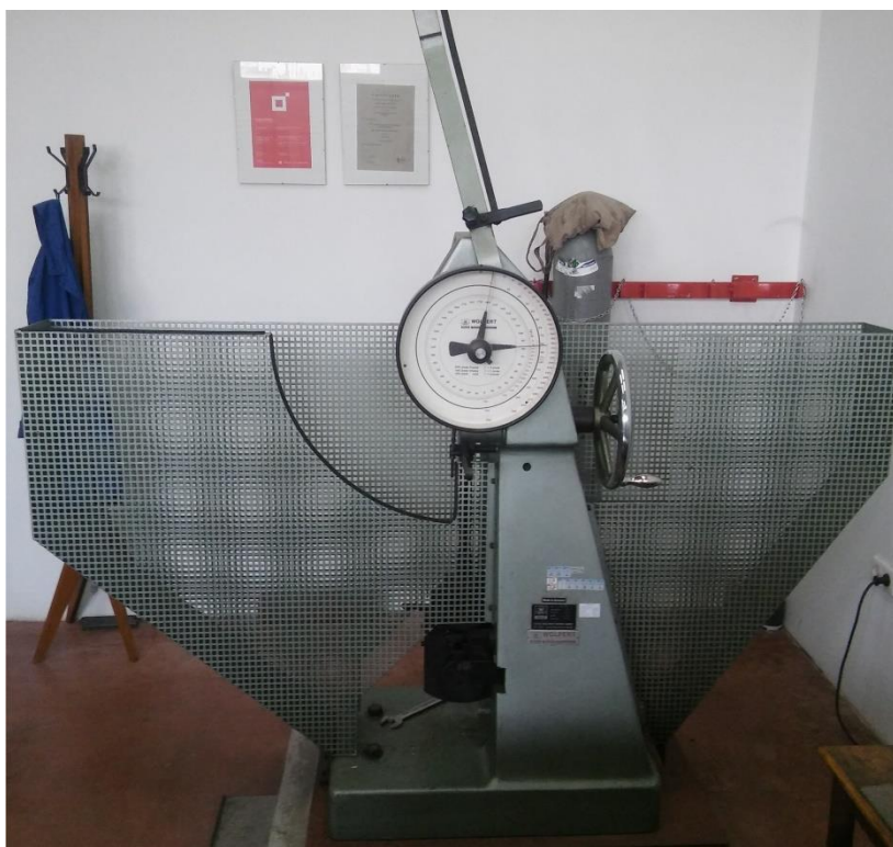
Slika 37. Charpyjev bat „Otto Wolpert-Werke GmbH“
