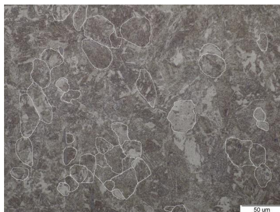
Slika 31. Određivanje veličine zrna
