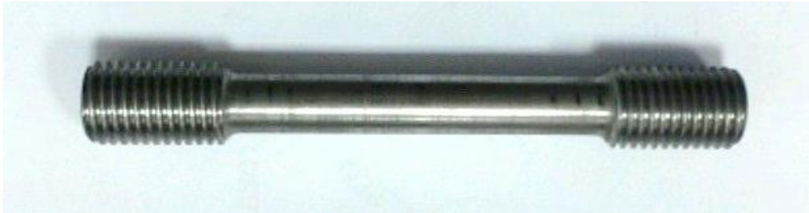
Slika 34. Epruveta za statičko vlačno ispitivanje
