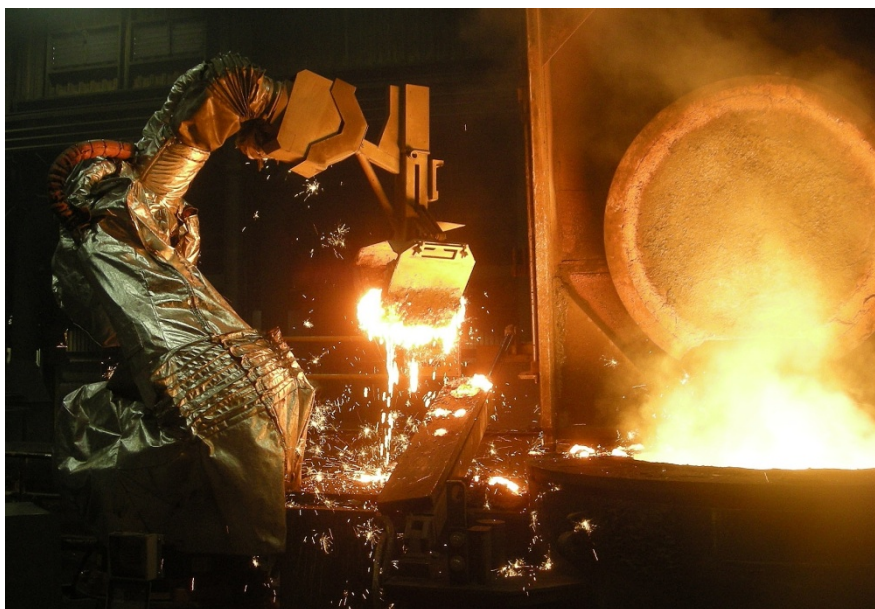
Slika 1. Rad robota u ljevaonici
