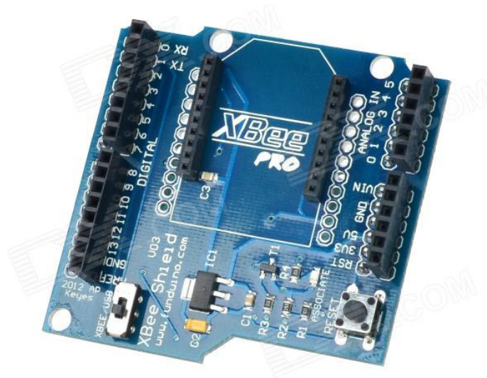
Slika 27. XBee štit ( engl.shield )
