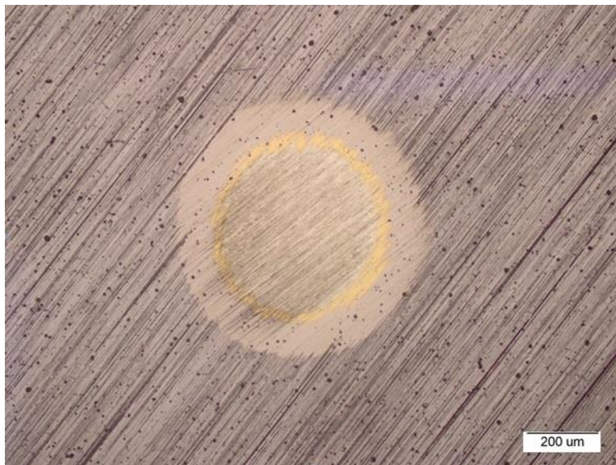
Slika 31. Otisak kalote na uzorku D2 02
