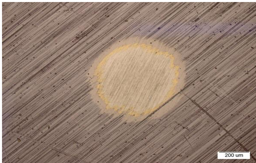
Slika 28. Otisak kalote na uzorku C2 01
