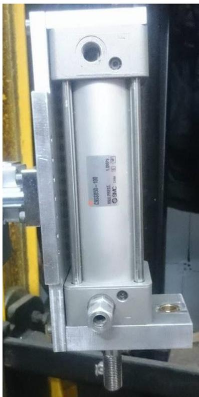
**Slika 36. Spoj cilindra C95SB50-100**
