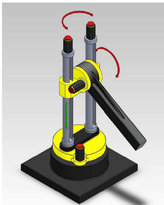
Slika 2. Stupnjevi slobode običnog manipulatora
