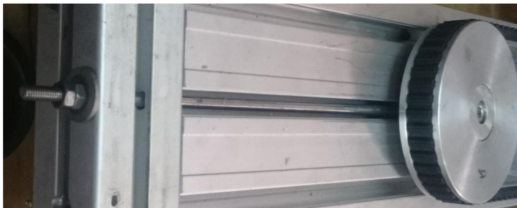
Slika 30. Zategnuti remen preko remenice 2
