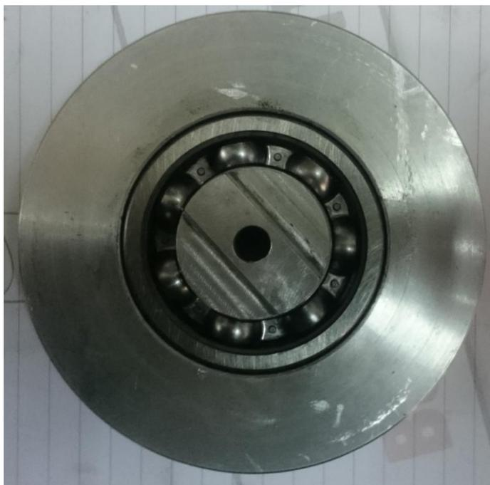
**Slika 27. Remenica 2 s kugličnim ležajem**
