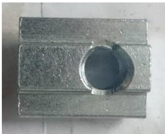
Slika 28. Predložak za utore profiliranog stola
