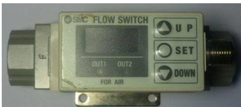
**Slika 60. Digitalni prekidač protoka**
