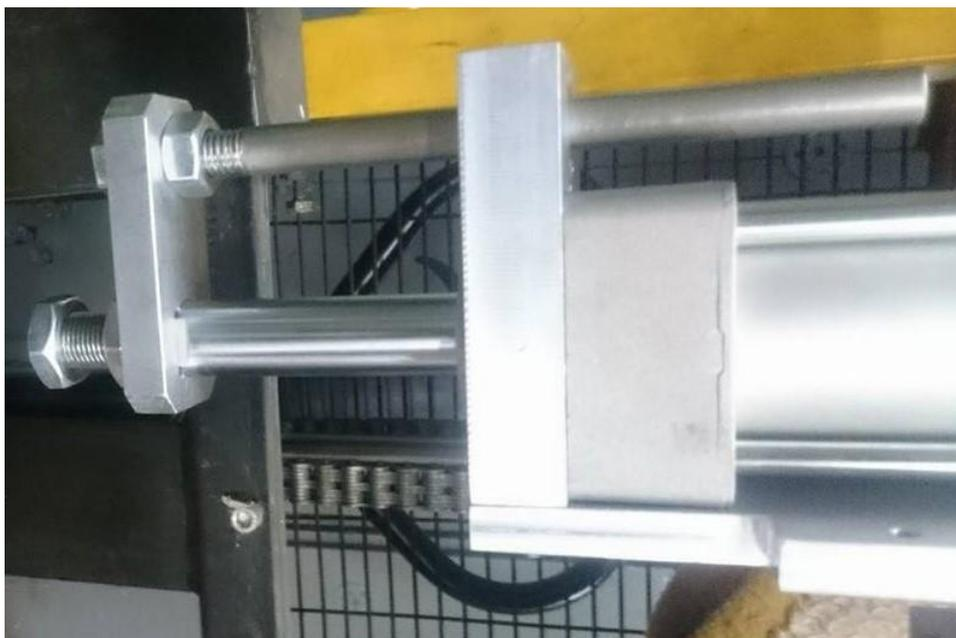
**Slika 37. Vodilica cilindra C95SB50-100**
