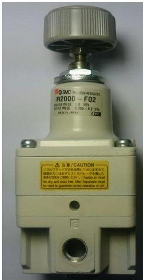
Slika 56. Precizni regulator IR 2000 – F02
