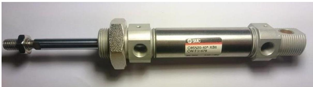
Slika 19. Cilindar C85N20-40\*-XB6
