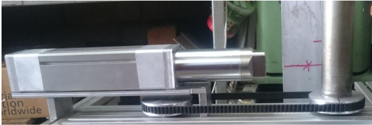
Slika 32. Spoj nosača za cilindar za profilirani stol
