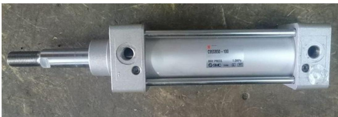
Slika 14. Cilindar C95SB50-100
