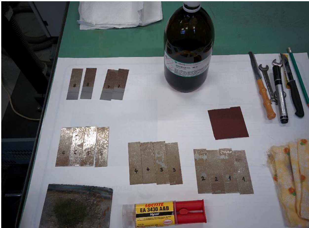
Slika 37. Uzorci od konstrukcijskog čelika i oprema korištena pri lijepljenju
