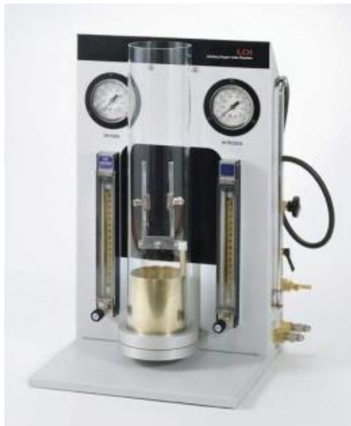
Slika 5. Uređaj za mjerenje indeksa kisika [28]
