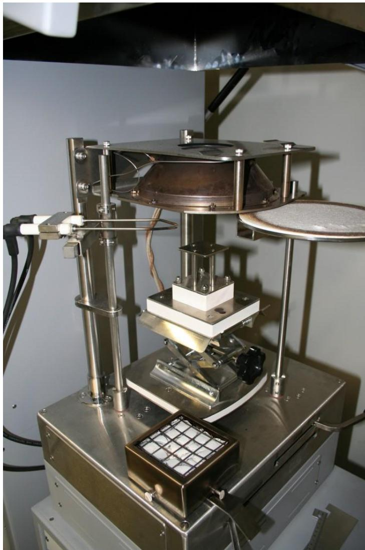
Slika 6. „Cone calorimeter” [30]
