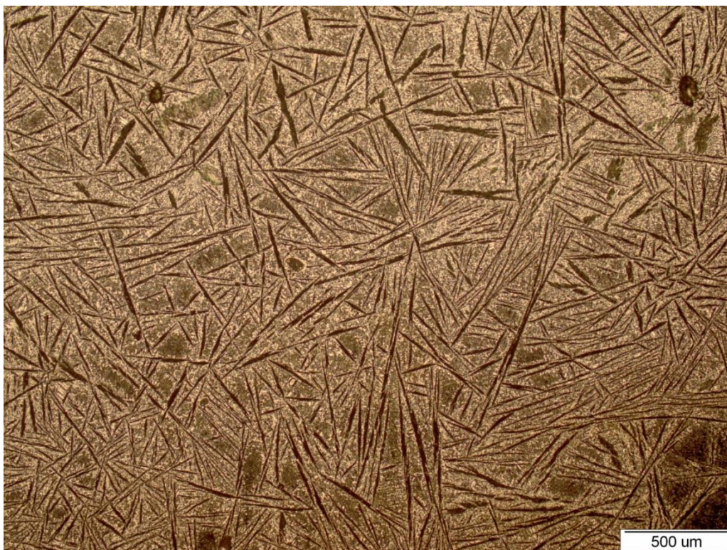
Slika 31. Mikrostruktura tvrdog navarenog sloja uzorka H3-3
