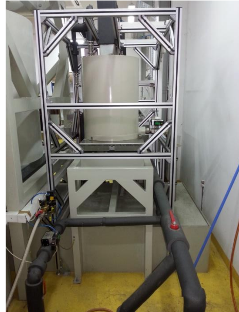
Slika 20. Spremnik za prikupljanje vode tijekom ispitivanja
