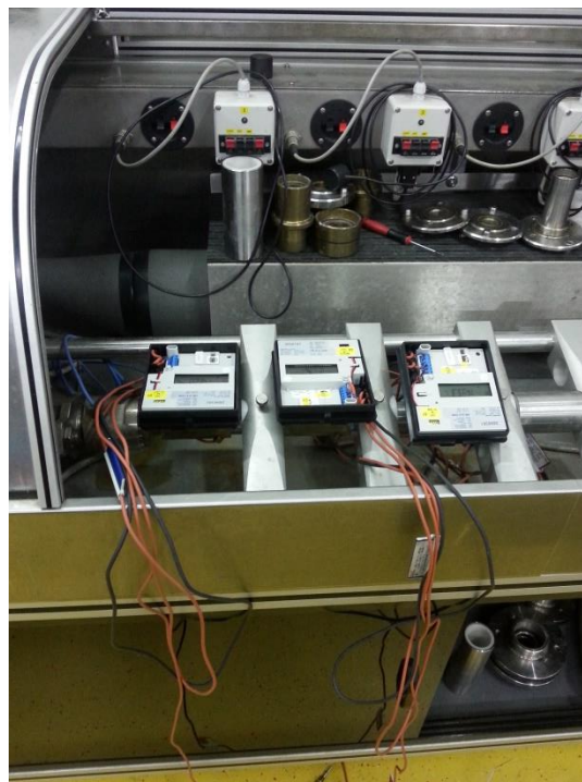
Slika 21. Spajanje mjerila protoka na ispitno mjesto
