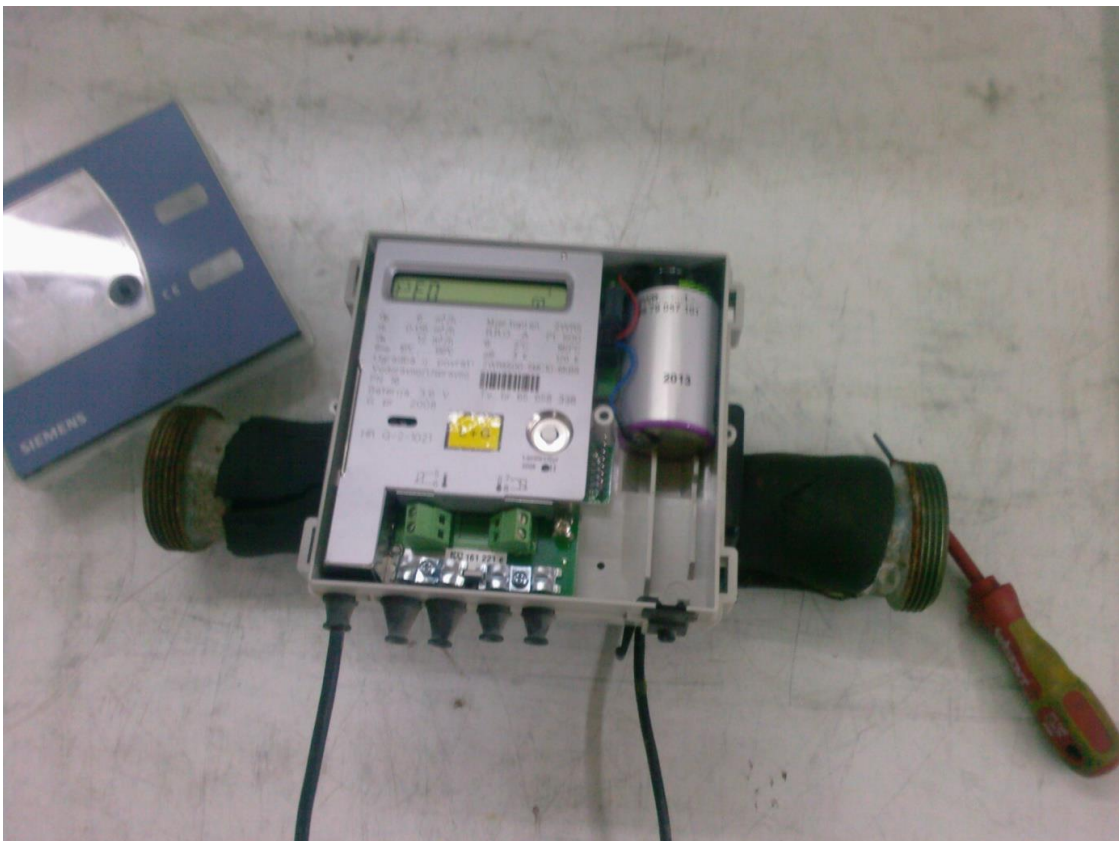
Slika 25. Primjer ispitivanja računске jedinice
