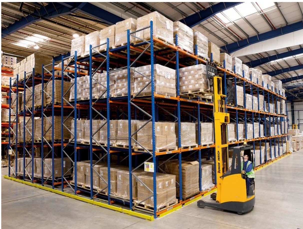
Slika 10. Protočni regali s guranjem (eng. Push Back Rack ) [11]
