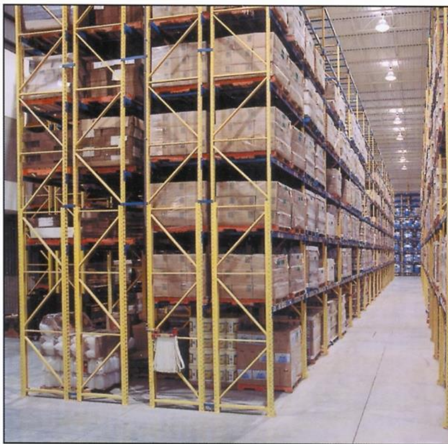
Slika 7. Paletni regali dvostruke dubine (eng. Double-Deep Pallet Rack ) [8]
