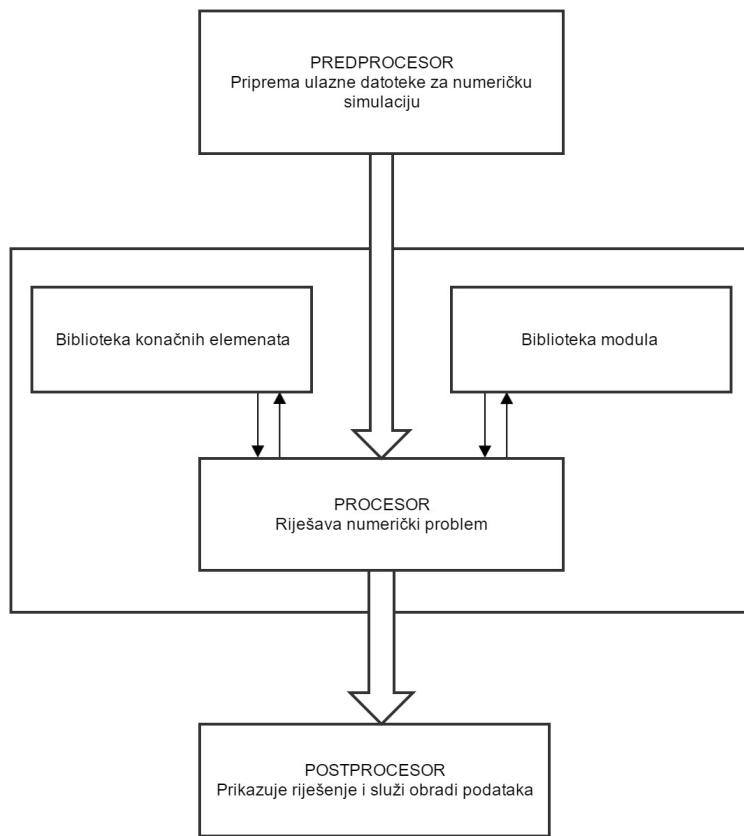
Slika 9 Shematski prikaz programa za rješavanje numeričkih simulacija
