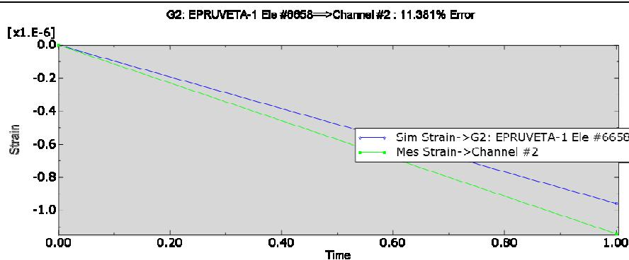
Slika 47 Dijagram razlike između izmjereni i izračunatih deformacija za tenzometar broj 2
