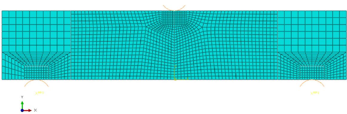
Slika 11 Epruveta diskretizirana s 1968 CPS4 konačna elementa
