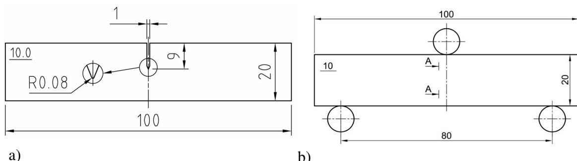
Slika 2 Oblak i dimenzije epruveta: a) SENB epruveta za ispitivanje u tri točke, b) Epruveta bez zareza za ispitivanje u tri točke
