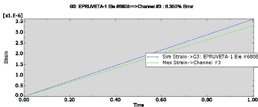
Slika 48 Dijagram razlike između izmjereni i izračunatih deformacija za tenzometar broj 3
