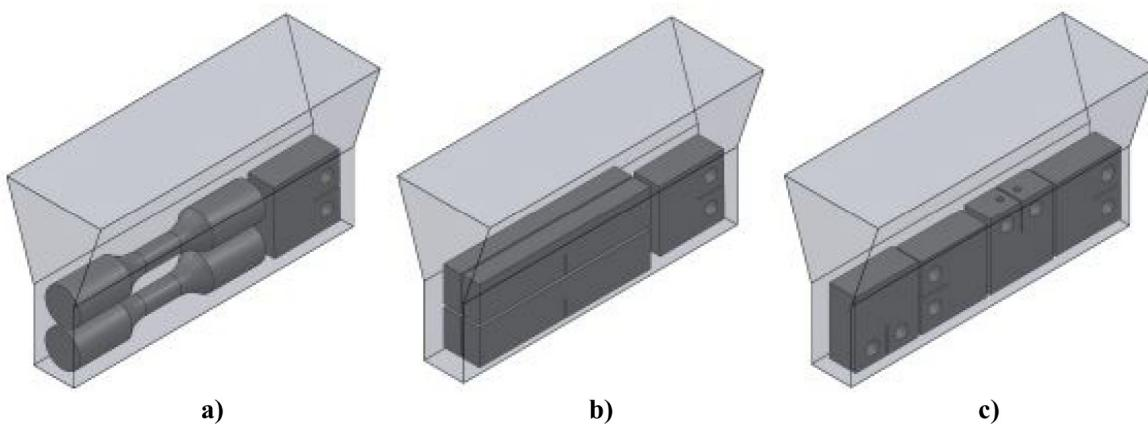
Slika 1 Orientacija epruveta u odljevcima Y-proba: a) Cilindrična, b) SENB i c) CT epruveta [1]
