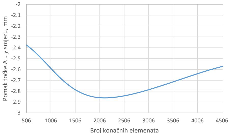
Slika 19 Konvergencija rješenja savijanja epruvete iz aluminijске legure
