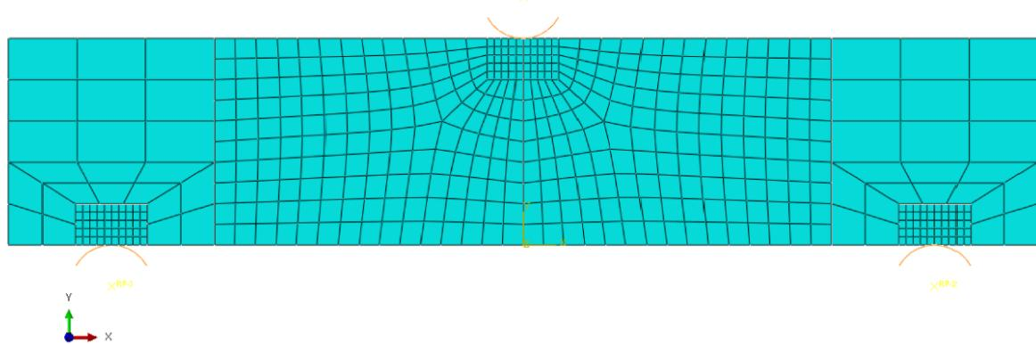
Slika 10 Epruveta diskretizirana s 506 CPS4 konačna elementa
