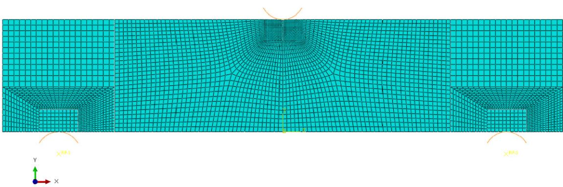
Slika 12 Epruveta diskretizirana s 4522 CPS4 konačna elementa
