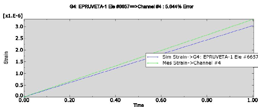
Slika 49 Dijagram razlike između izmjereni i izračunatih deformacija za tenzometar broj 4
