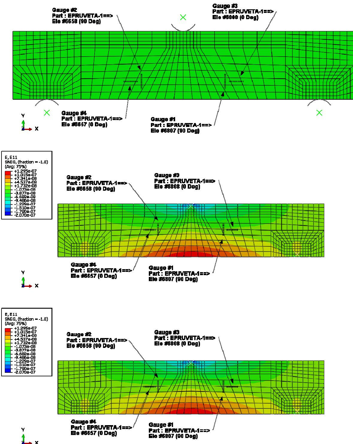
Slika 43 Prikaz položaja i orijentacije tenzometarskih traka na površini epruvete
