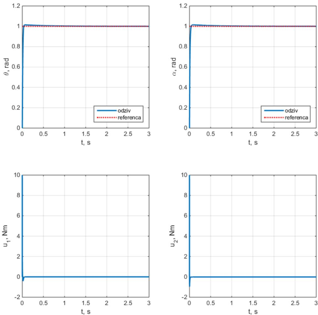
Slika 3.5 Odziv sustava reguliranog PID regulatorom
