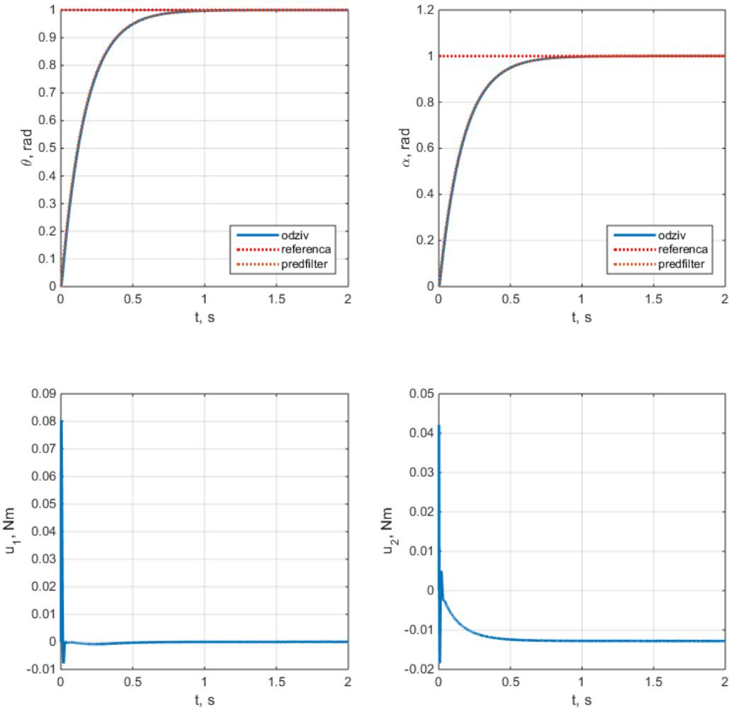
Slika 3.9 Odziv sustava s PID regulatorom i predfiltrom referentne pozicije
