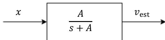
**Slika 3.10 Blok shema filtra za estimaciju brzine**
