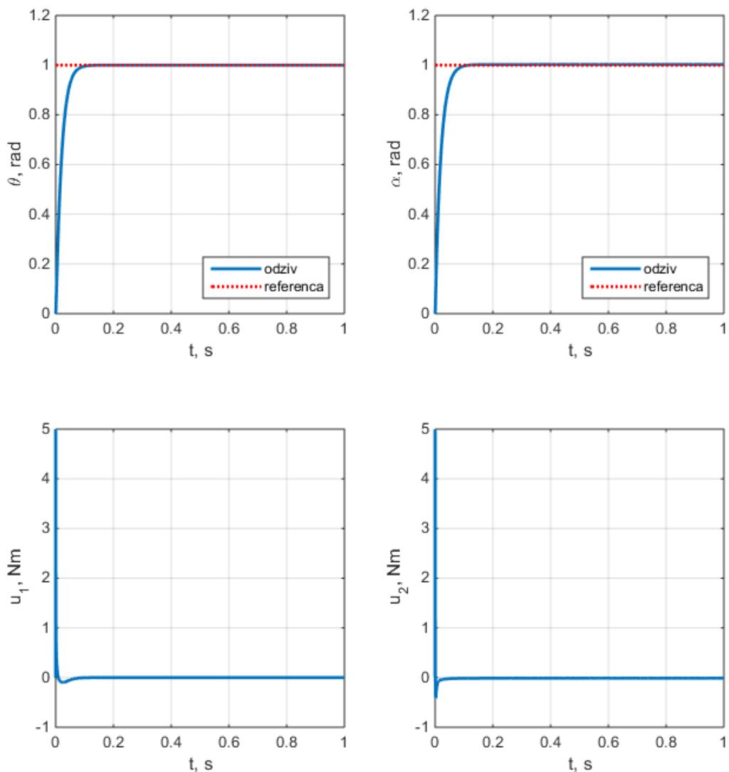
**Slika 3.2 Odziv sustava reguliranog PD regulatorom**
