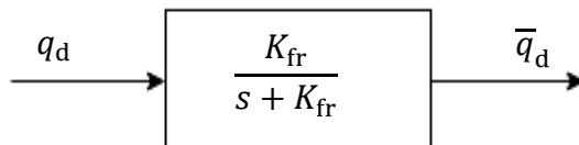
Slika 3.7 Blok shema filtra referentne pozicije
