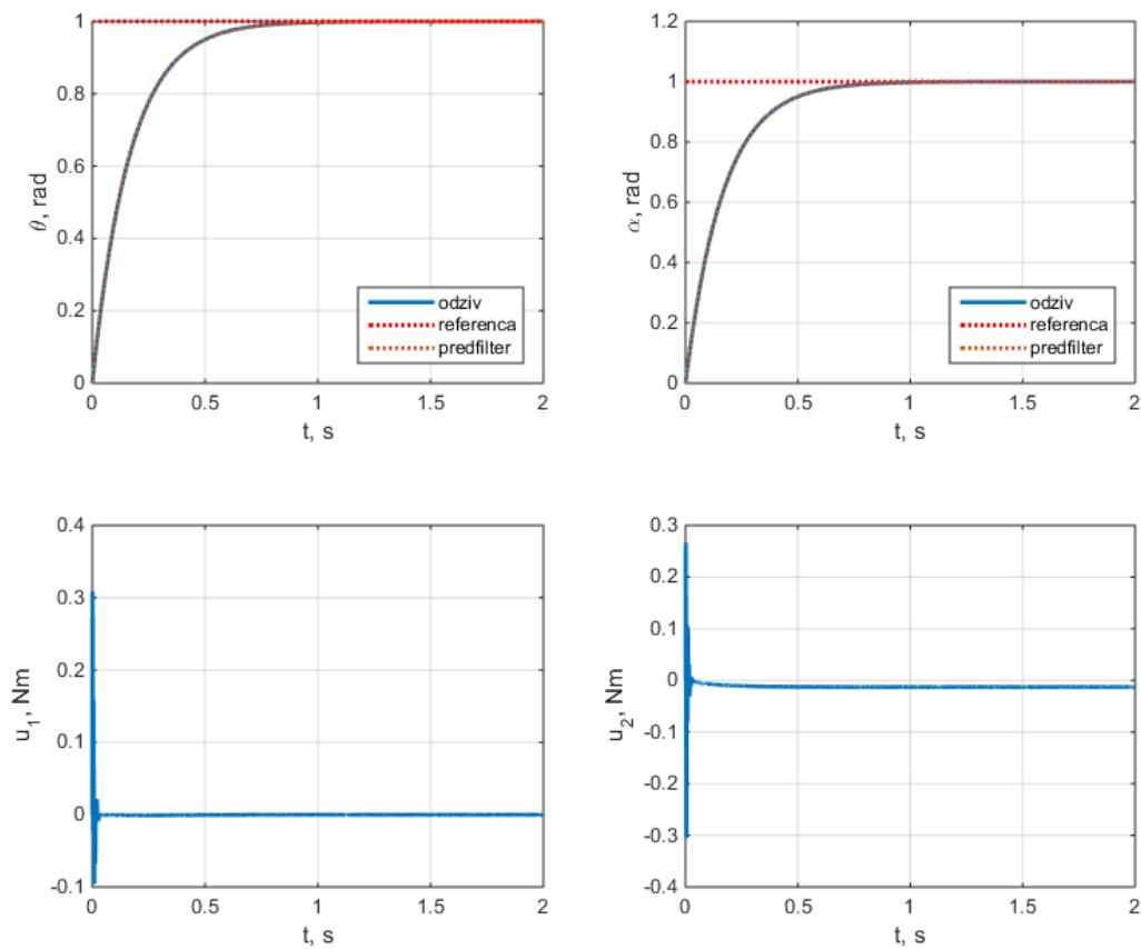
**Slika 3.14 Odziv PID regulatora bez šuma mjerena, uz filter brzine**
