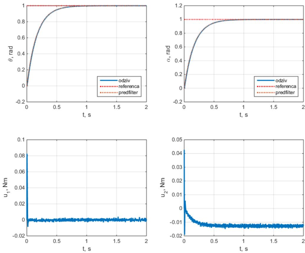
**Slika 3.12 Odziv PID regulatora uz šum mjerena, bez filtra brzine**
