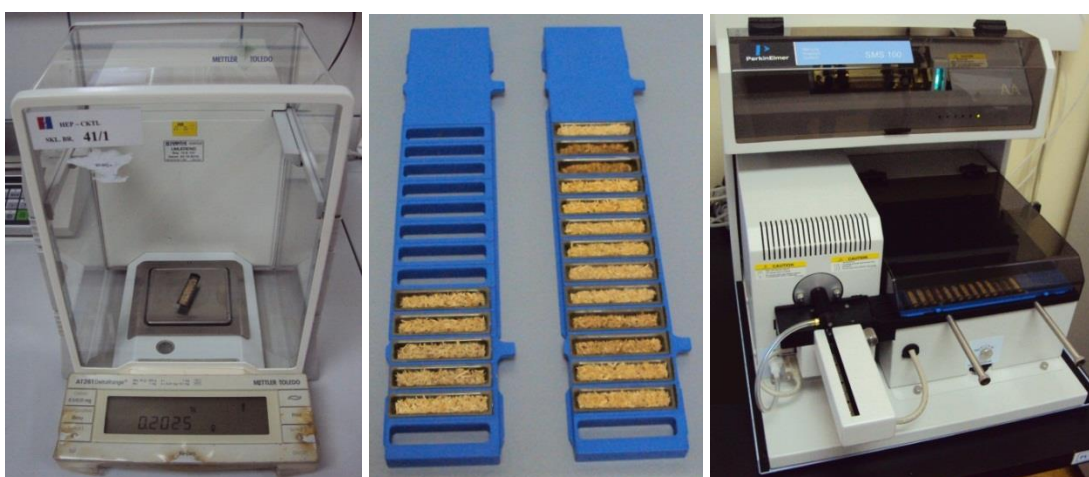
Slika 38. Vaganje uzorka (lijevo), nosači s uzorcima (sredina) u analizatoru žive (desno)
