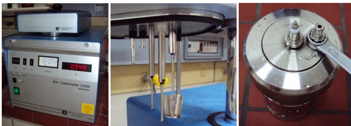
Slika 26. Kalorimetar tijekom izgaranja (lijevo), poklopac kalorimetra (sredina) i otpuštanje nepovratnog ventila (desno)
