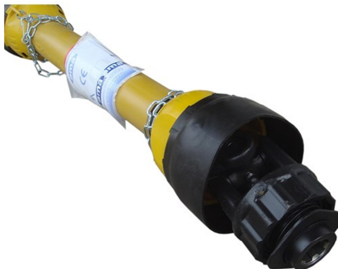
Slika 24. Kardansko vratilo sa sigurnosnom spojkom
