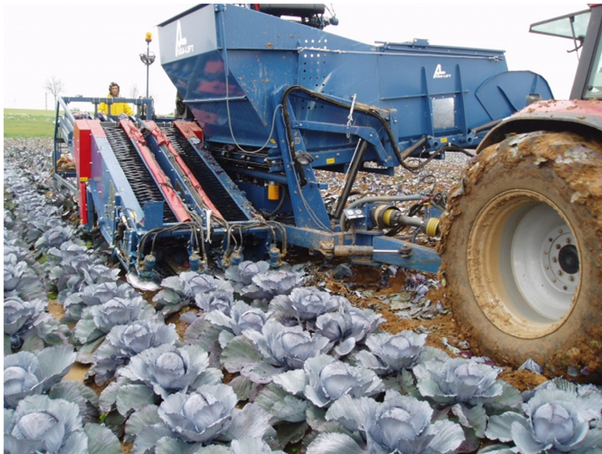
Slika 18. Dvoredni uređaj za branje kupusa
