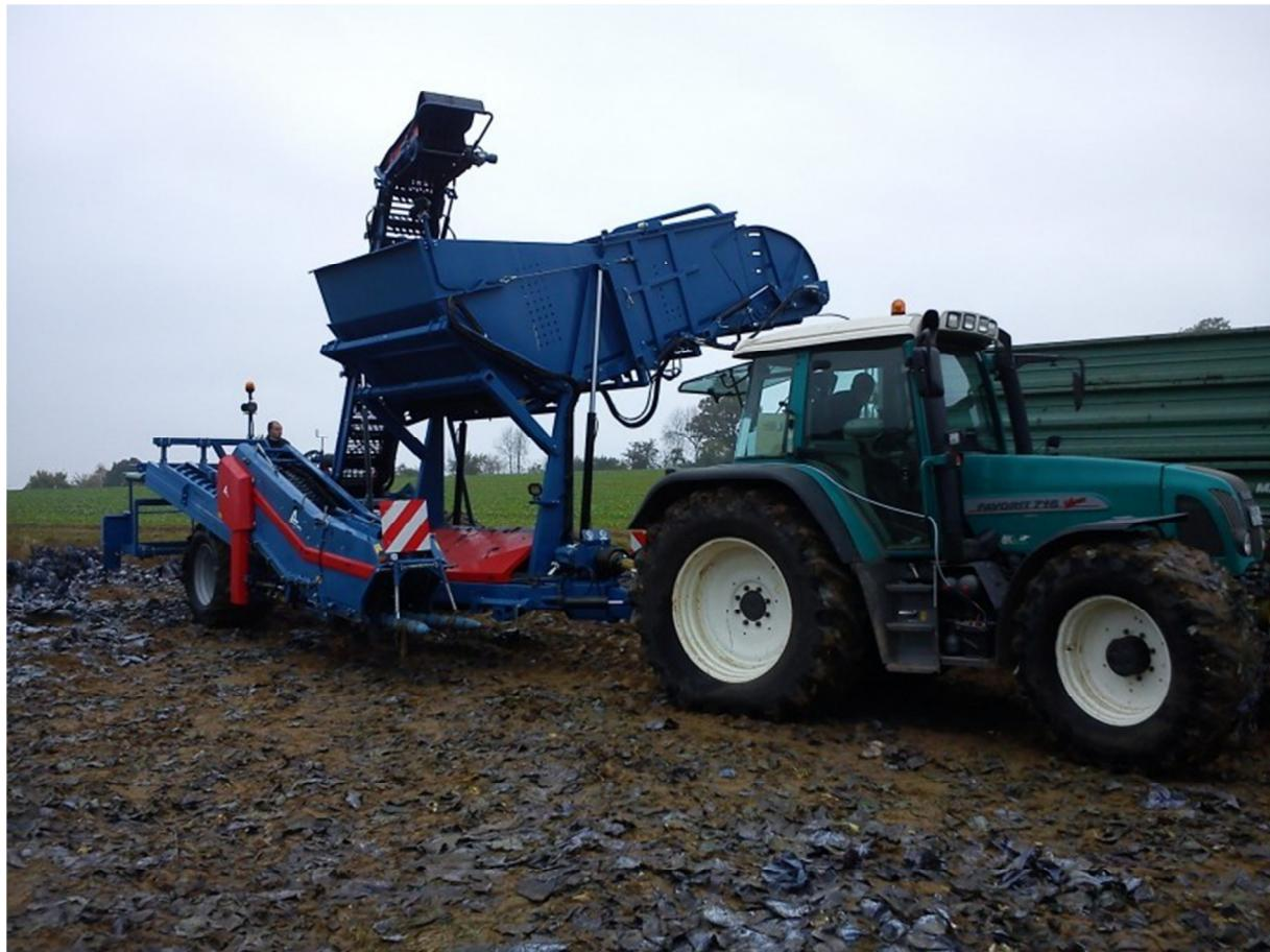
**Slika 17. Traktorski priključak za vađenje kupusa sa spremnikom**
