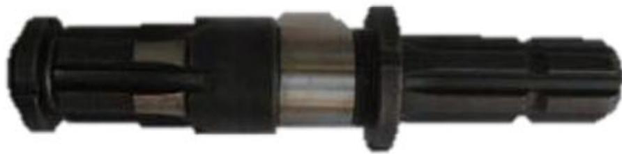
Slika 22. Izlazno vratilo traktora
