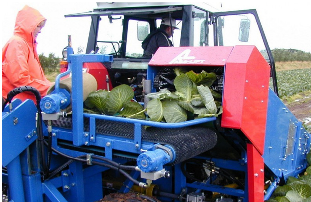
Slika 13. Ulaz kupusa na čistač
