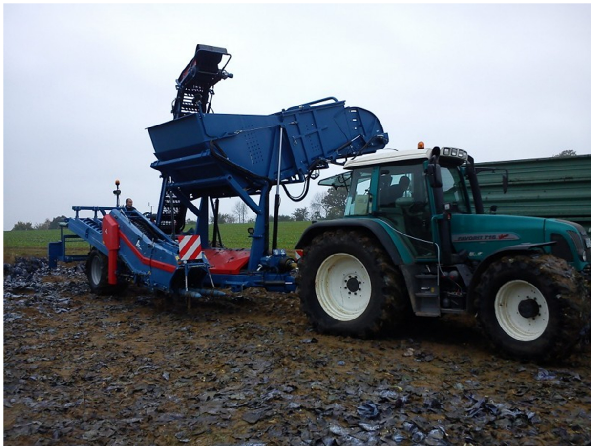
Slika 17. Traktorski priključak za vađenje kupusa sa spremnikom
