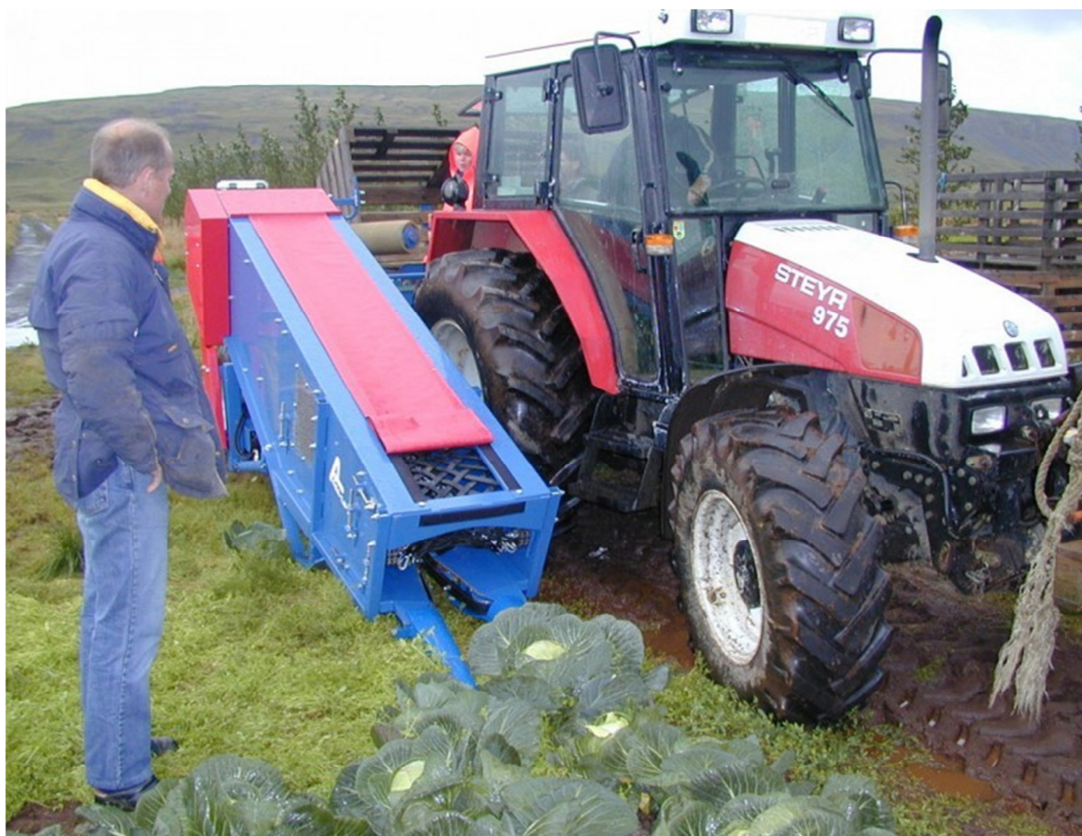
Slika 12. Traktorski priključak za vadenje kupusa MK-1000
