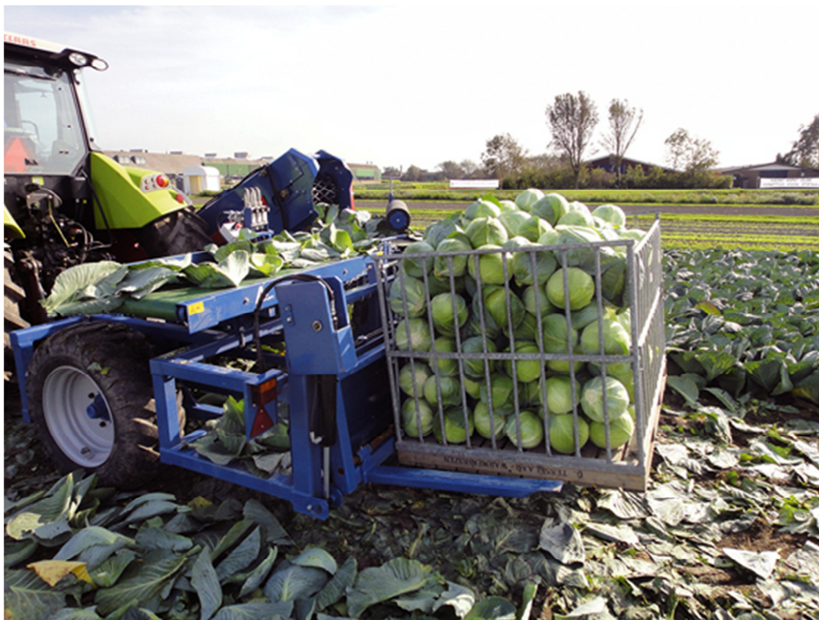
Slika 14. Prikaz prihvata sanduka za spremanje kupusa
