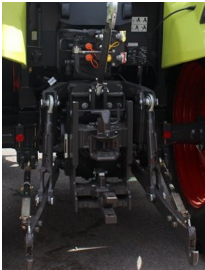
Slika 21. Traktorska kuka sa prilagodljivom visinom
