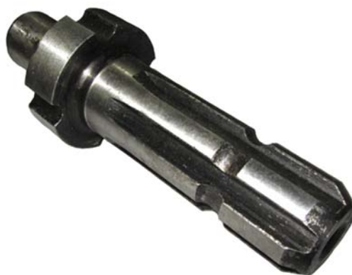
Slika 6. Izlazno vratilo sa 540 min -1
