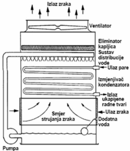
Slika 3. Evaporativni kondenzator
