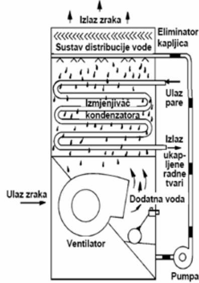
Slika 4. Evaporativni kondenzator
