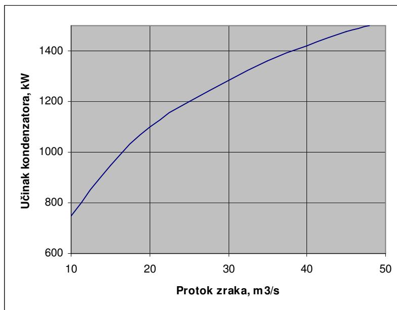
Slika 10. Utjecaj promjene protoka zraka na učinak kondenzatora
