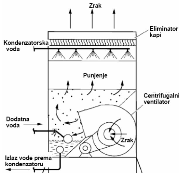
Slika 1. Protusmjerni rashladni toranj s tlačnim strujanjem
