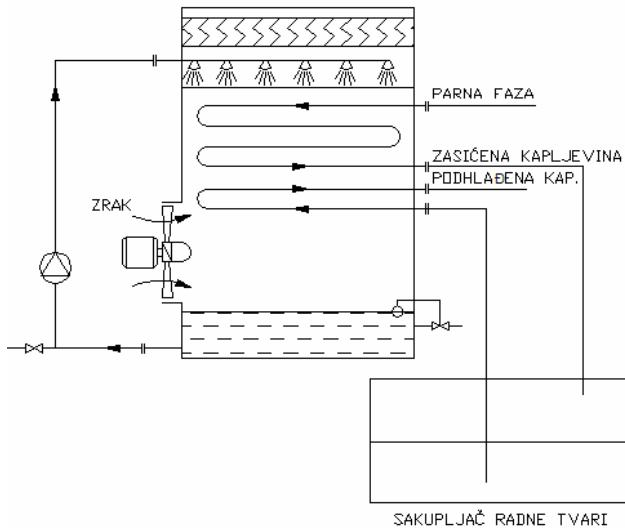
Slika 11. Podhlađivanje kapljivite radne tvari dodatnim ocjevljenjem
