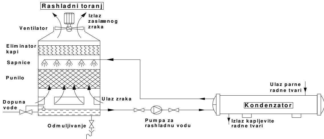
Slika 5. Protusmjerni rashladni toranj s induciranim strujanjem
