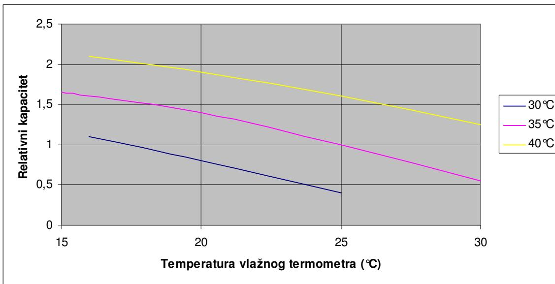
Slika 7. Relativni kapacitet evaporativnog kondenzatora kao funkcija temperature kondenzacije i temperature vlažnog termometra
