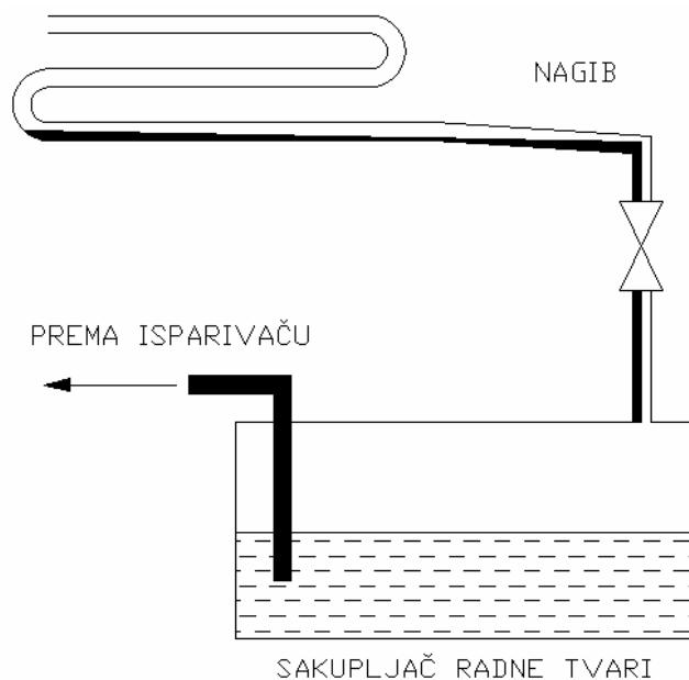
Slika 16. Pravilno ocjevljenje kondenzatora sa sakupljačem radne tvari
