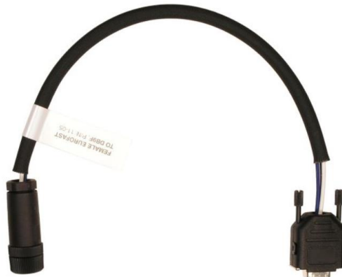
Slika 5.17. Adapter sa Eurofast priključnice analizatora na DB9F priključnicu [7].
