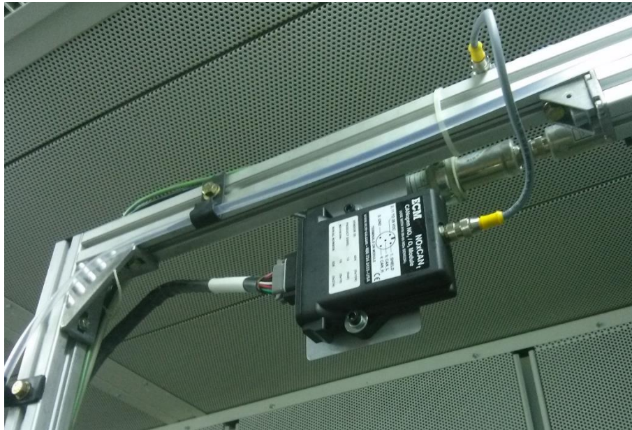
Slika 4.1. Upravljački modul postavljen na nosač i spojen sa senzorom.
