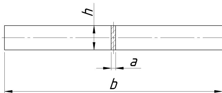
**Slika 82. Dimenzije nosivog lima matice trapeznog vretena**
