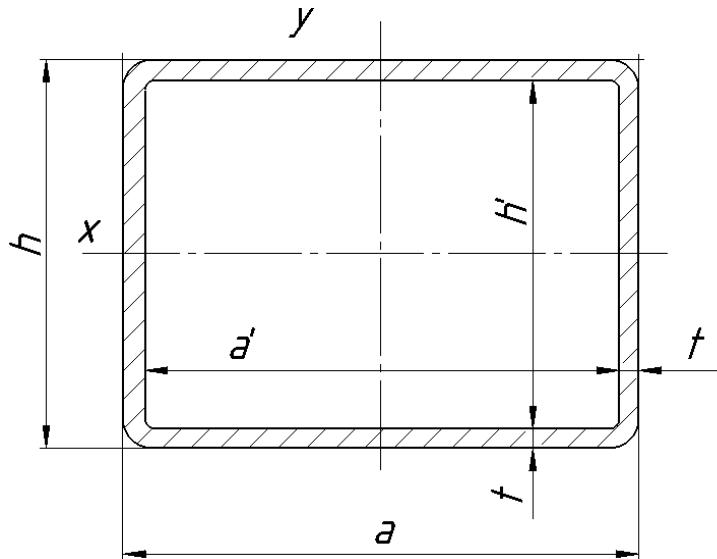
**Slika 84. Poprečni presjek profila noge nosive konstrukcije**
