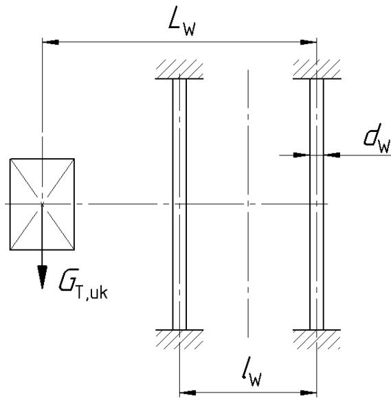
**Slika 79. Opterećenje vodilica nosača konvejerske trake**
