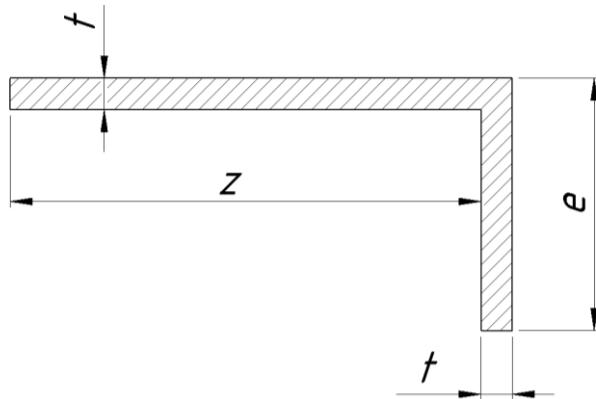
**Slika 83. Presjek nosivog lima podizača konvejerske trake**
