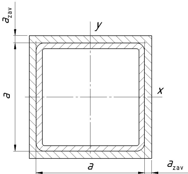
**Slika 77. Dimenziye zavara nosača spremnika**
