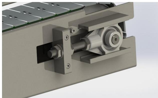
**Slika 69. Pritezanje konvejerskog lanca ležajem u posebno oblikovanom kućištu**
