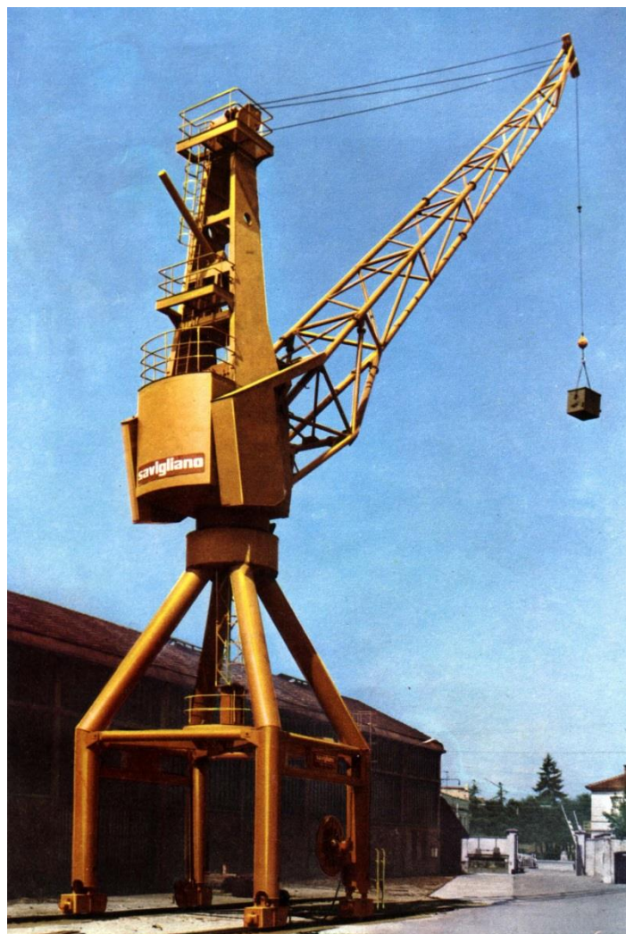
Slika 2.2. Okretni granik s jednokrakim dohvatnikom tvrtke SAVIGLIANO
