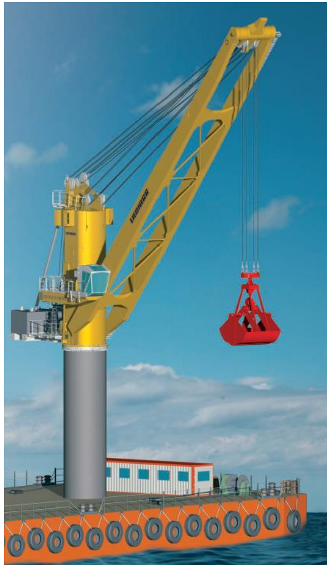
Slika 2.4. Okretni granik s jednokrakim dohvatnikom tvrtke Konecranes
