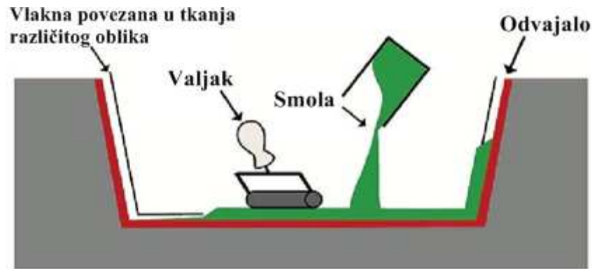
Slika 2.21. Proizvodnja kompozita laminiranjem [6]
