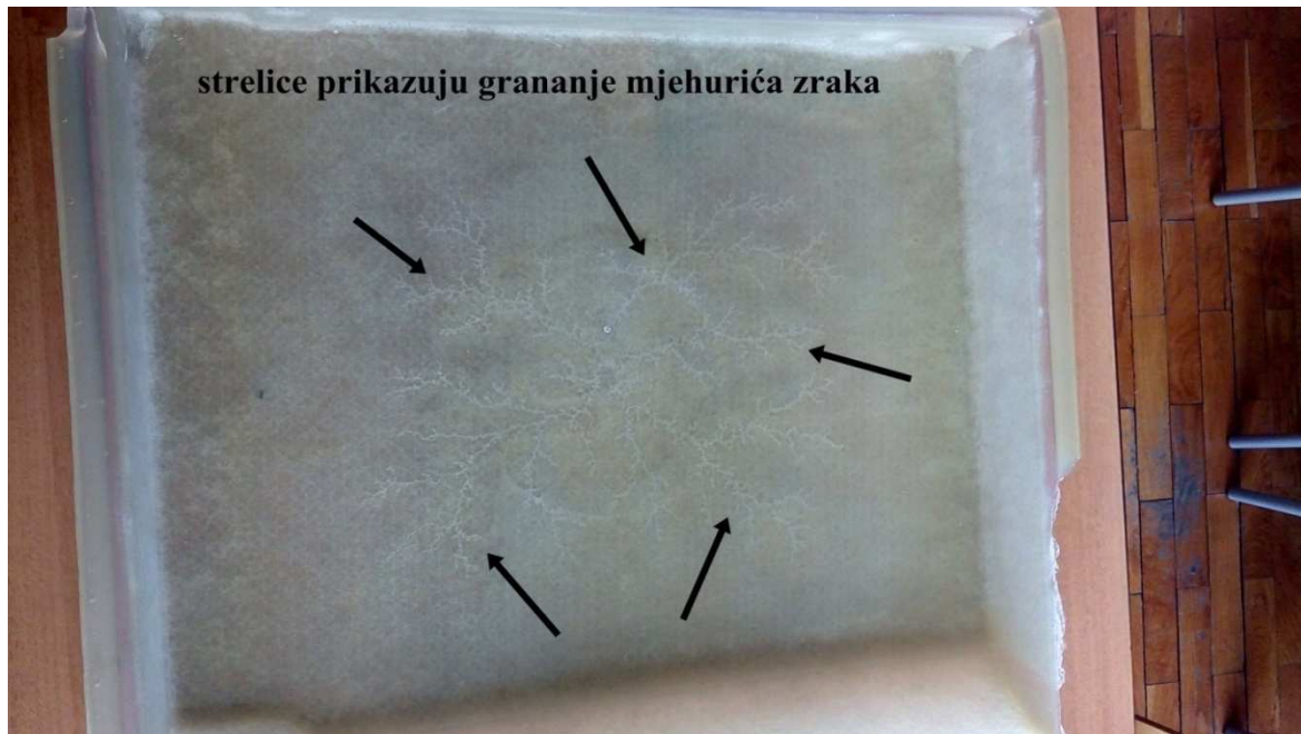
Slika 3.15. Greške na kompozitnoj tvorevini nakon provedenog postupka LRTM - grananje mjehurića zraka (pogled na cijeli proizvod)
