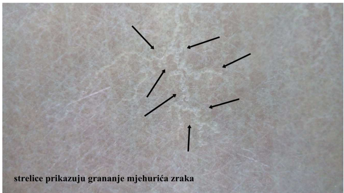
Slika 3.16. Greške na kompozitnoj tvorevini nakon provedenog postupka LRTM - grananje mjehurića zraka (uvećano mjesto)
