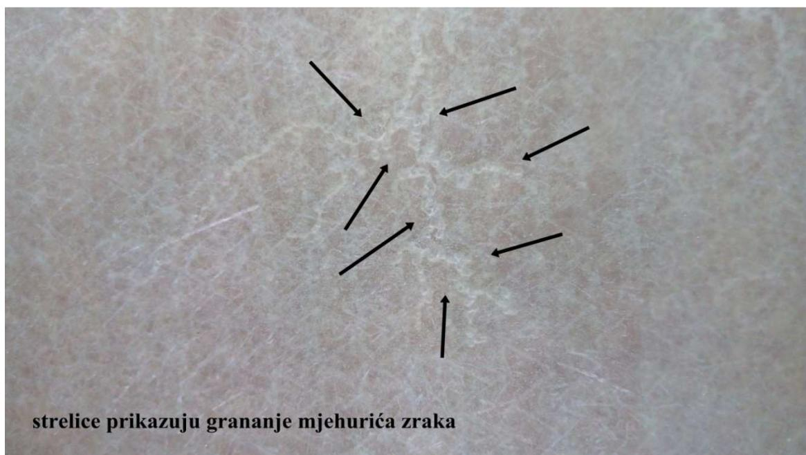
Slika 3.16. Greške na kompozitnoj tvorevini nakon provedenog postupka LRTM - grananje mjeđužarića zraka (uvećano mjesto)
