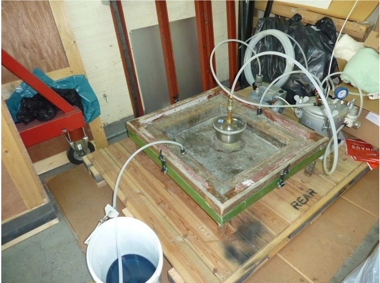
Slika 4.16. Gašenje pumpe i ostavljanje smole da potpuno umreži kroz 24 sata
