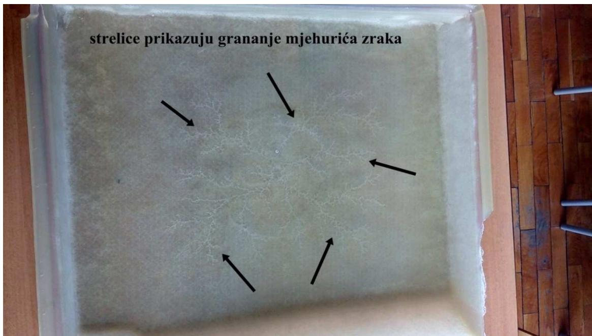
Slika 3.15. Greške na kompozitnoj tvorevini nakon provedenog postupka LRTM - grananje mjeđužarića zraka (pogled na cijeli proizvod)
