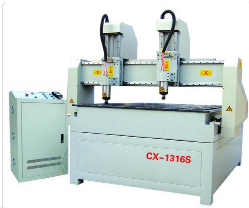
Slika 11. CNC stroj s dvije obradne glave [8]
