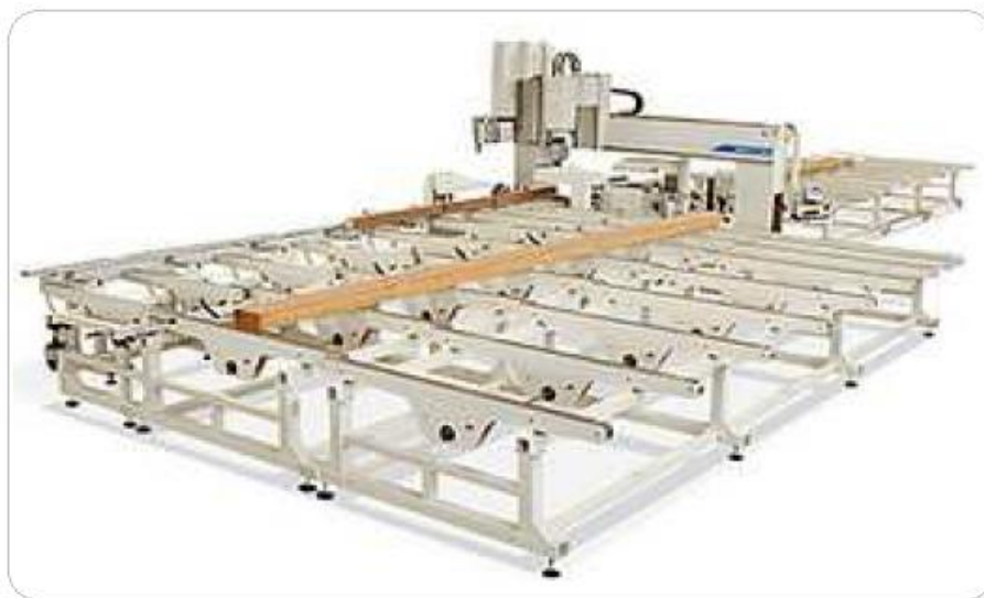
Slika 16. CNC stroj za obradu drvenih greda [8]
