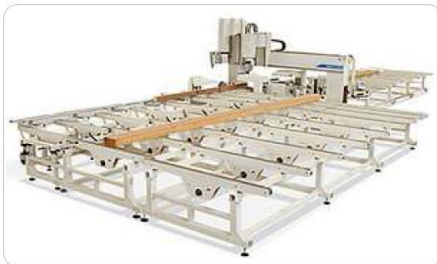
Slika 16. CNC stroj za obradu drvenih greda [8]
