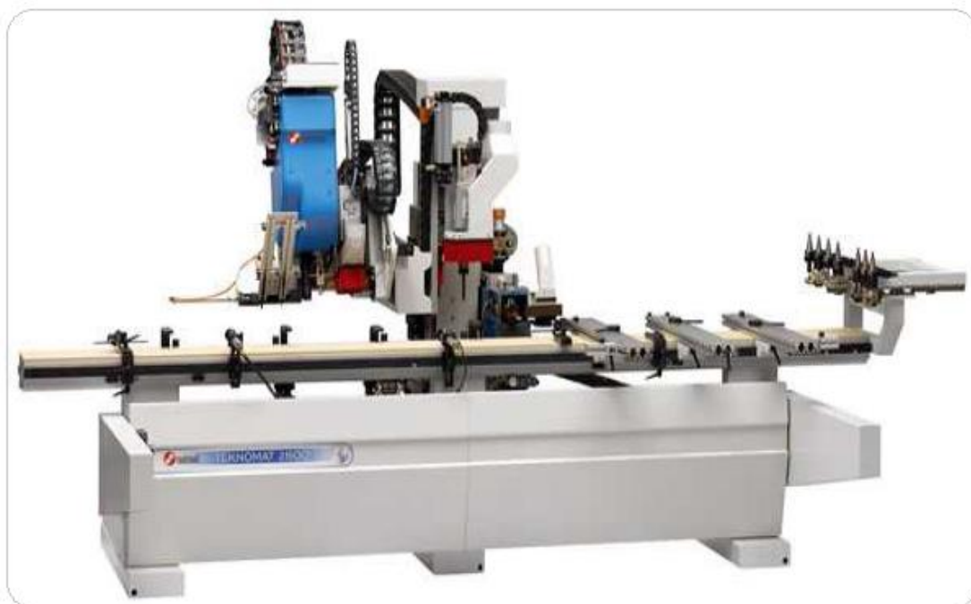
Slika 14. Obradni centar za bušenje provrta i montažu okova kod proizvodnje prozora [8]
