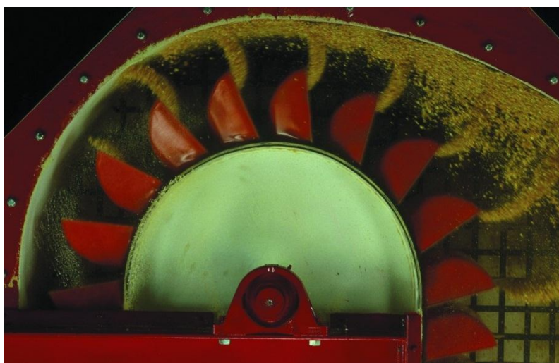
Slika 54. Centrifugalno pražnjenje elevatora [9]
