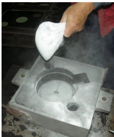
Slika 28. Posipanje gornjeg dijela kalupa
