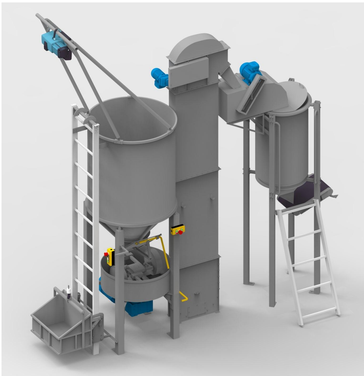
Slika 105. Postrojenje za pripremu kalupne mješavine pijeska u ljevaonicama
