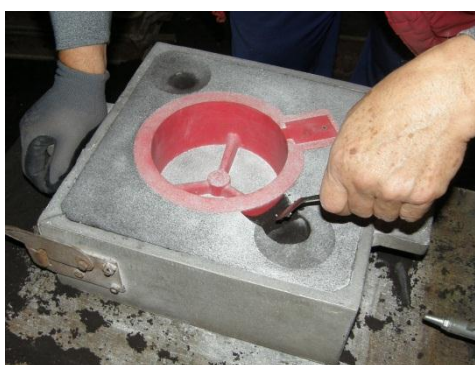
Slika 26. Pravljenje kanala za talinu
