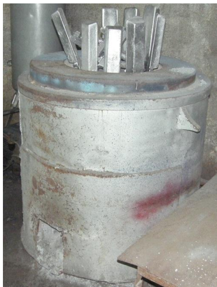
Slika 31. Stabilna lončana peć
