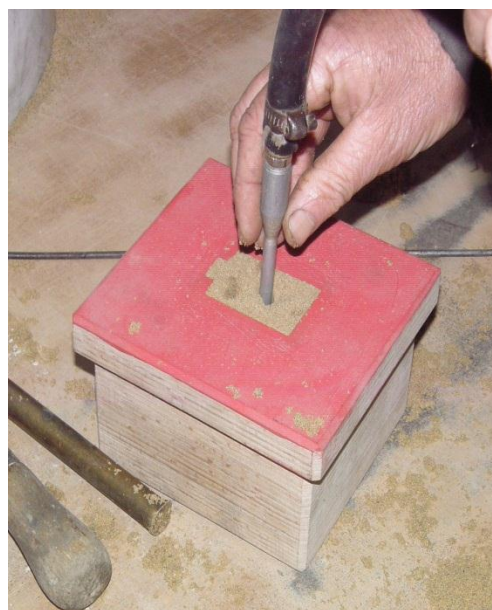
Slika 9. Propuhivanje plinom CO 2
