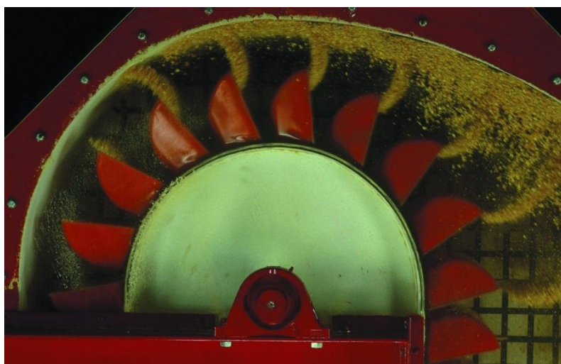
Slika 54. Centrifugalno pražnjenje elevatora [9]
